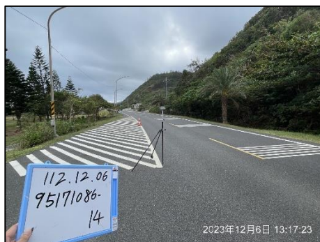
圖 2-68 正射影像地物平面精度檢查外業檢核作業照
