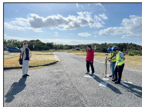
圖 2-68 正射影像地物平面精度檢查外業檢核作業照
