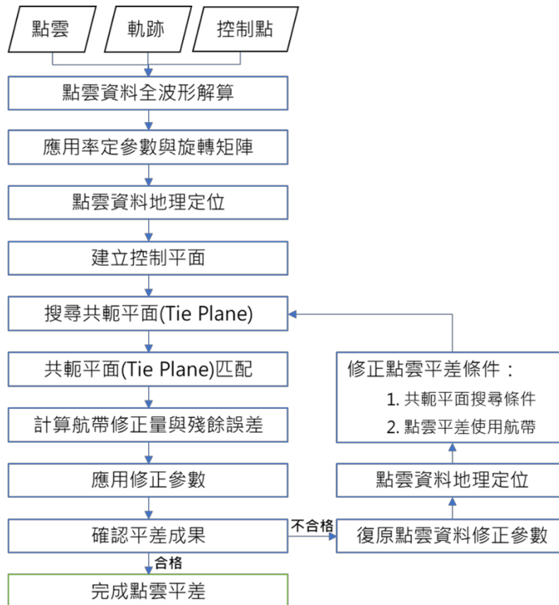
圖 2-30 點雲航帶平差作業流程
