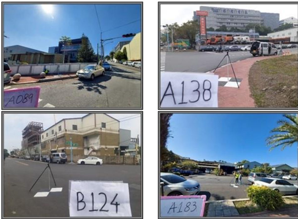
圖 2-15 南崗率定場地面高程檢核點施測作業照
