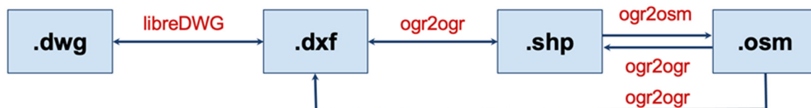
圖 4-16 DWG 格式轉換為 OSM 格式之流程
