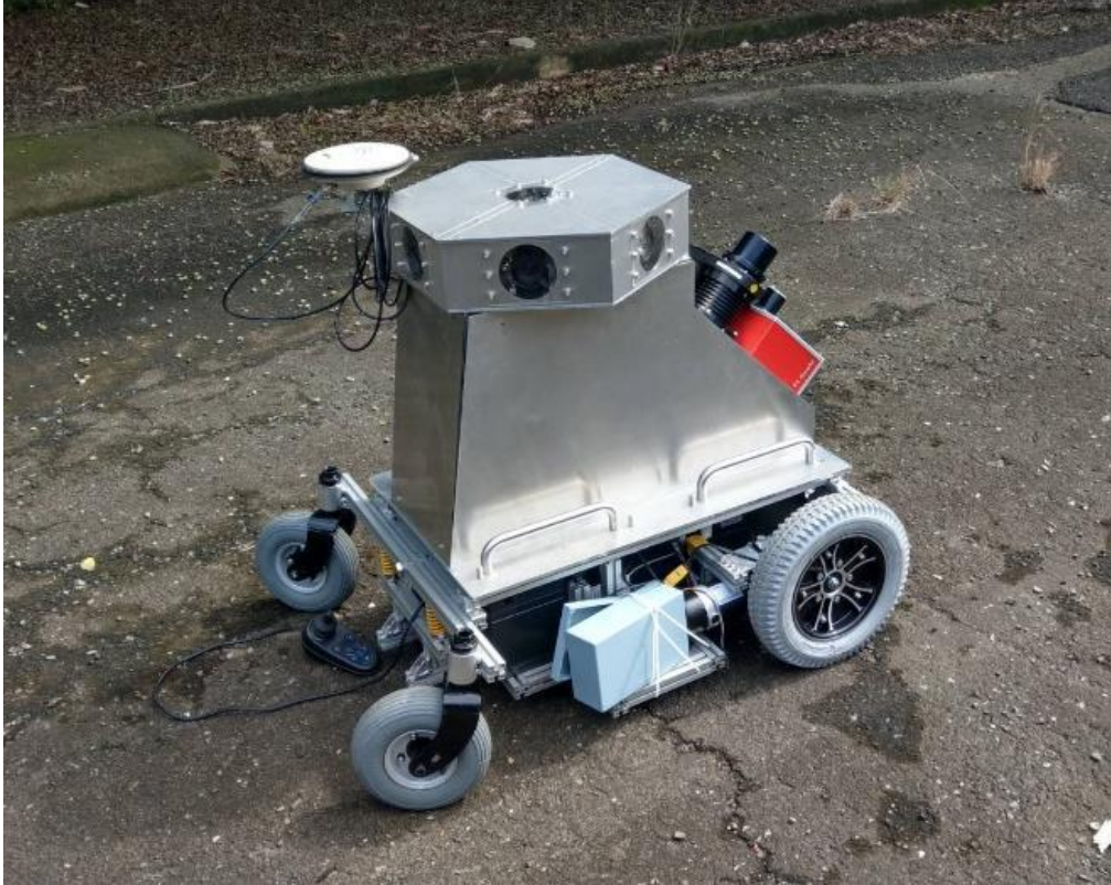
圖2-3 遙控光達系統
