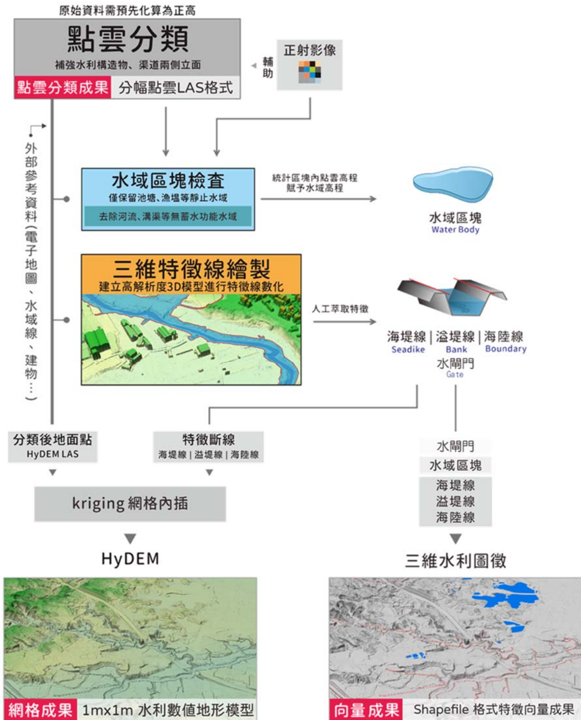
圖 2-1、水利數值地形資料集測製流程
