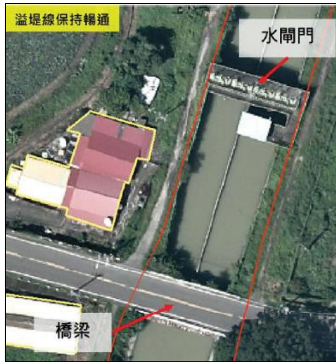
圖 2-20 溢堤線遇水閘門繪製原則(1)
