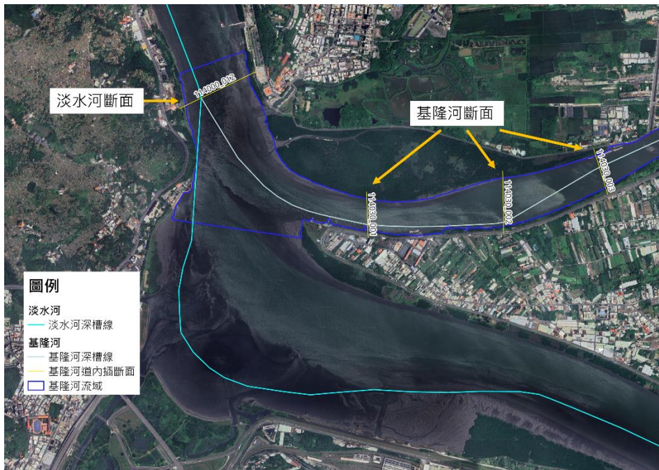
圖 2-51 基隆河道斷面網格內插作業
