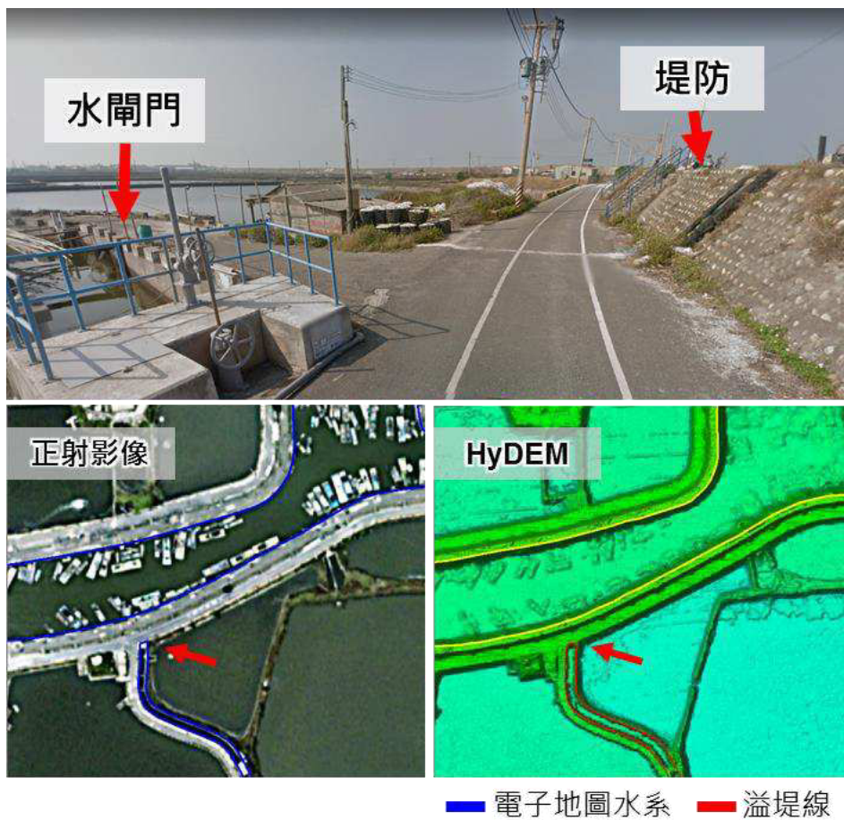
圖 2-21 溢堤線遇水閘門繪製原則(2)
