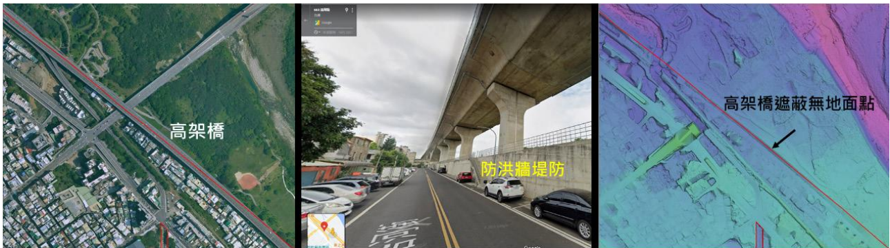
圖 2-23 高架橋光達點雲無法測繪出防洪構造物
