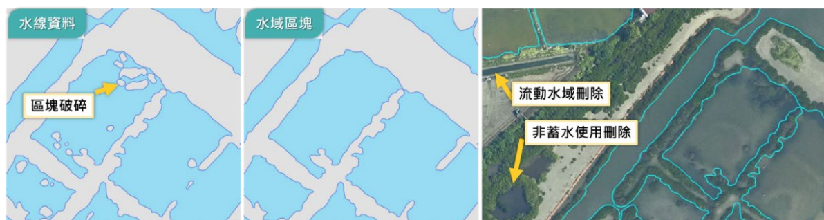
圖 4.16 水線編修以符合水域區塊規則 (圖幅號：94193076)
