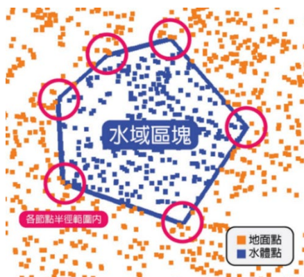
圖 4.23 水域區塊水面高程值與滿水位高程值計算方式
