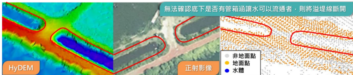
圖 4.10 溢堤線遇管箱涵繪製原則(圖幅號：94193015)
