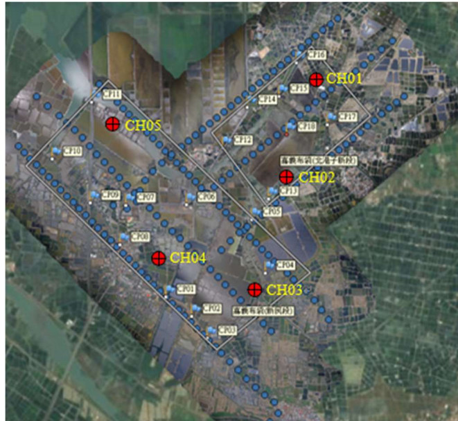
圖3-58 嘉義縣布袋鎮(北港子新段、新民段)控制點及檢核點分布圖
