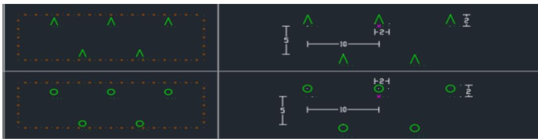
圖 2-2 地形圖圖式範例與尺寸基點設定示意
