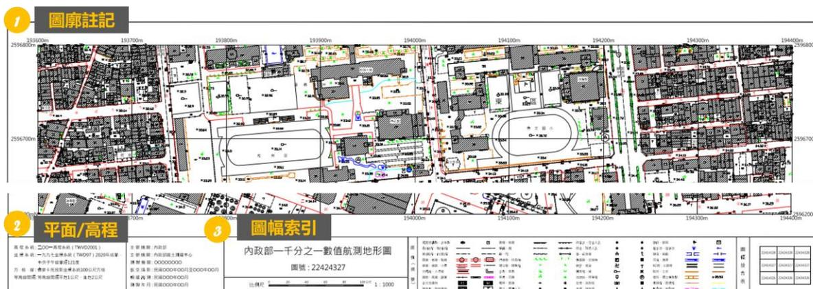
圖 3-24 1/1,000 地形圖圖幅圖廓(整飾)註記
