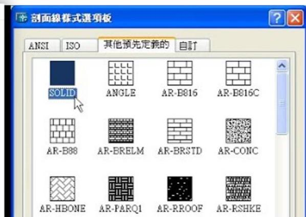
圖 3-6 AutoCAD 符號造字檔與自訂填充線檔結構與展示畫面
