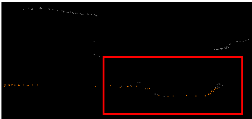
圖 5-4、排水溝立面之點雲剖面圖
