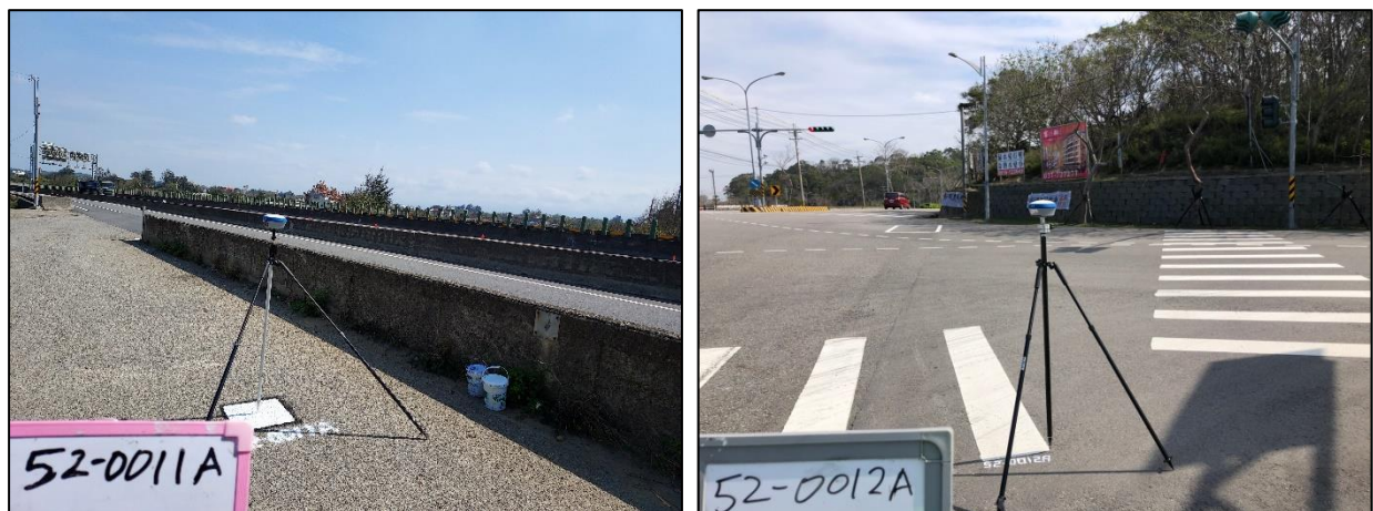
圖 2-5 地面 GNSS 衛星定位儀實際作業照
