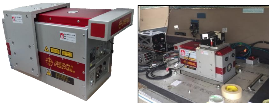
圖 2-2 空載光達 Riegl LMS-Q780 實機照
