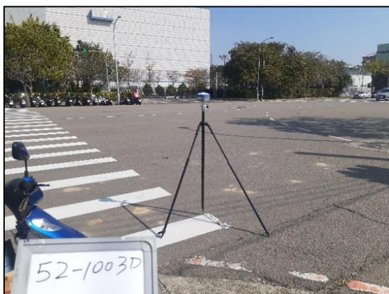
圖 2-61 橫斷面檢核點現場作業工作照
