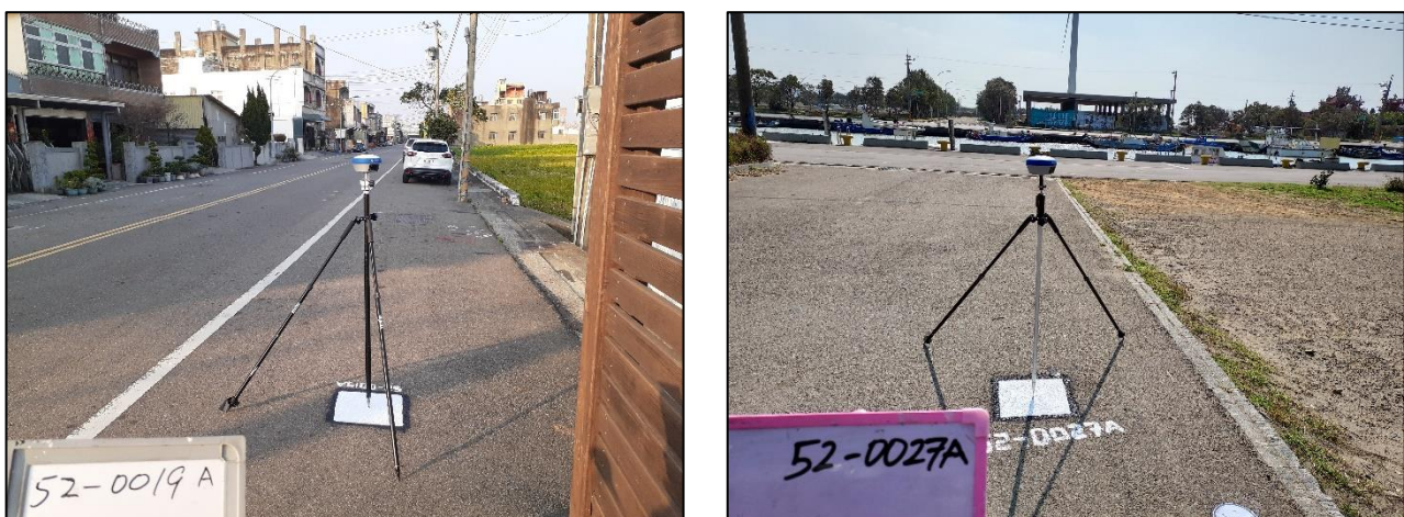
圖 2-30 平差控制點 VBS-RTK 工作照
