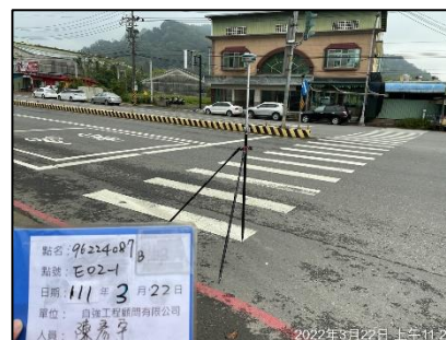
圖 2-82 正射影像地物平面精度檢查外業檢核作業照
