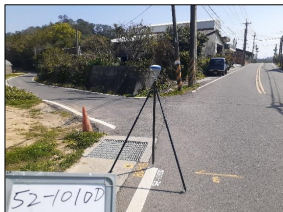
圖 2-61 橫斷面檢核點現場作業工作照
