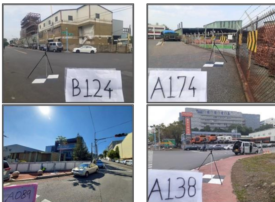
圖 2-27 南崗率定場地面高程檢核點施測作業照
