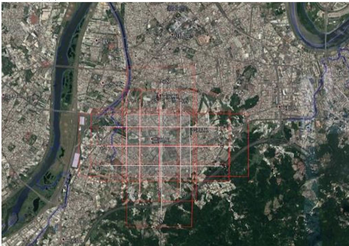
圖 2-15 板橋率定場航線規劃示意圖
