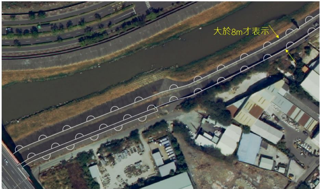
圖 6-3 雙層堤防圖面表示方式
