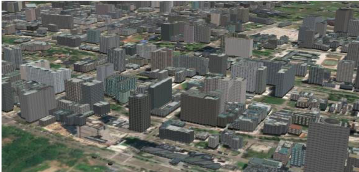
圖 2.8 三維近似化建物模型示意圖 (內政部國土測繪中心，2019)
