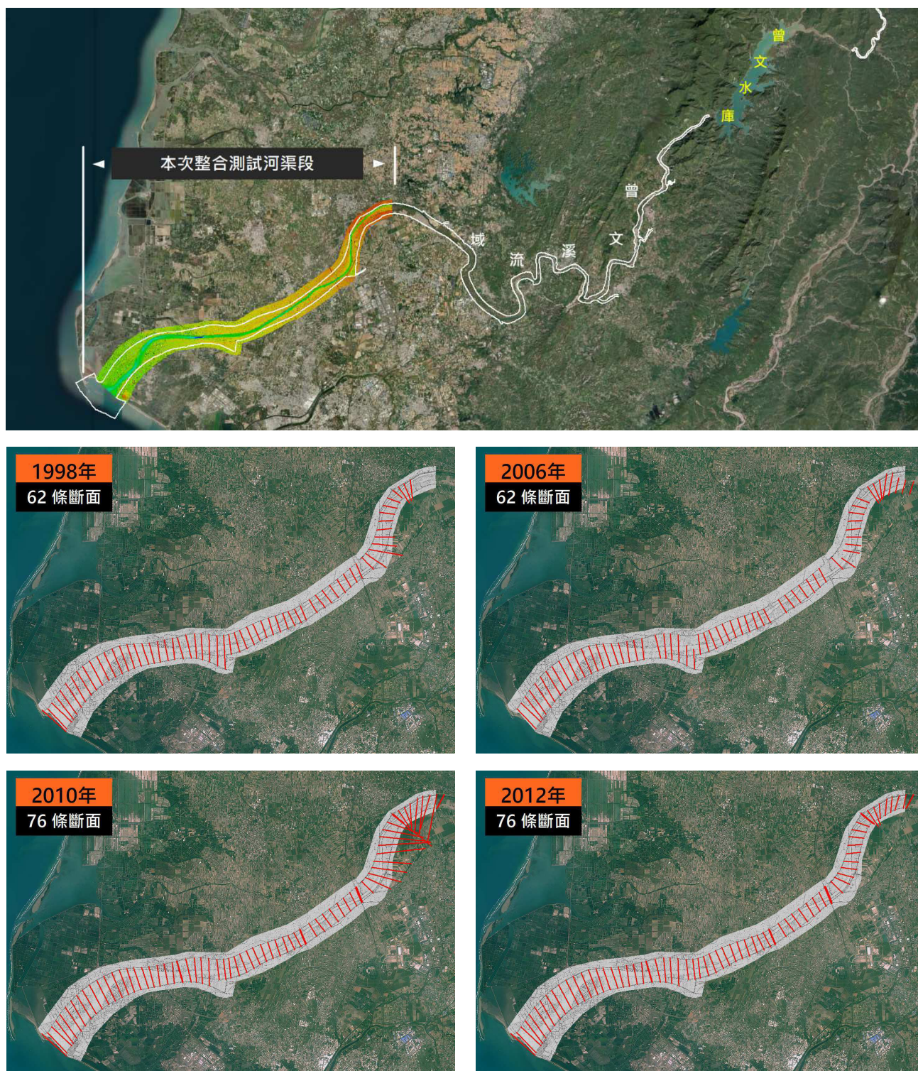
圖 6.12 曾文溪測試範圍多期斷面測量成果圖
