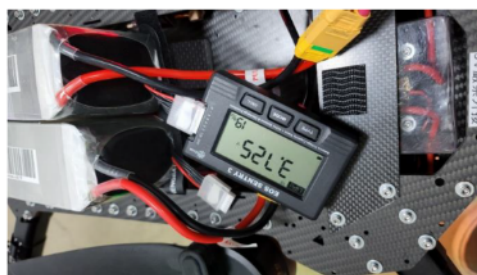
電池外觀 & 電池電壓
