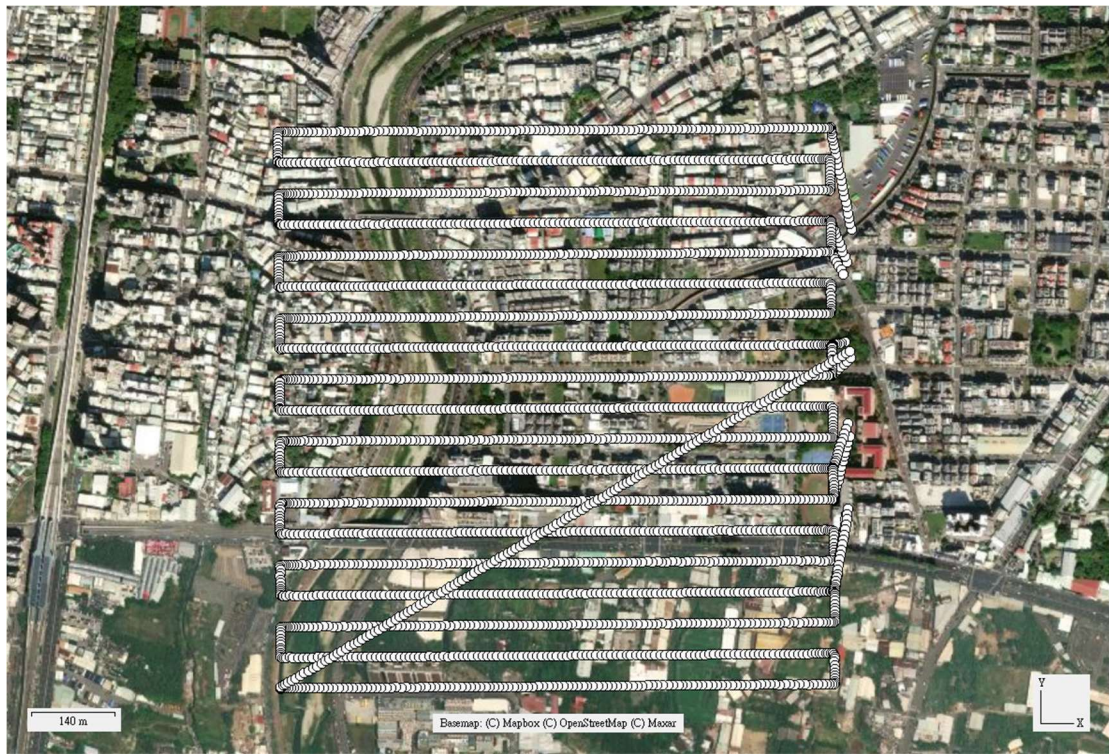
圖 3-12 臺中市北屯區飛行航線規劃
