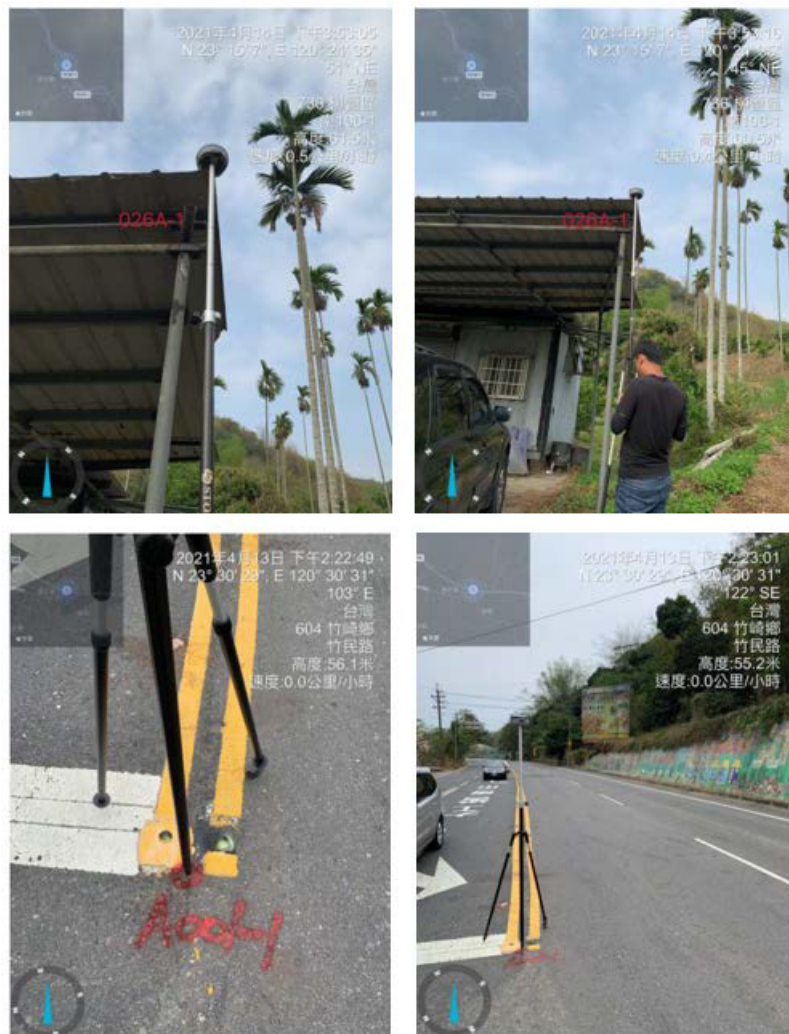
圖 2-11 航測控制與檢核點測量現場照片圖
