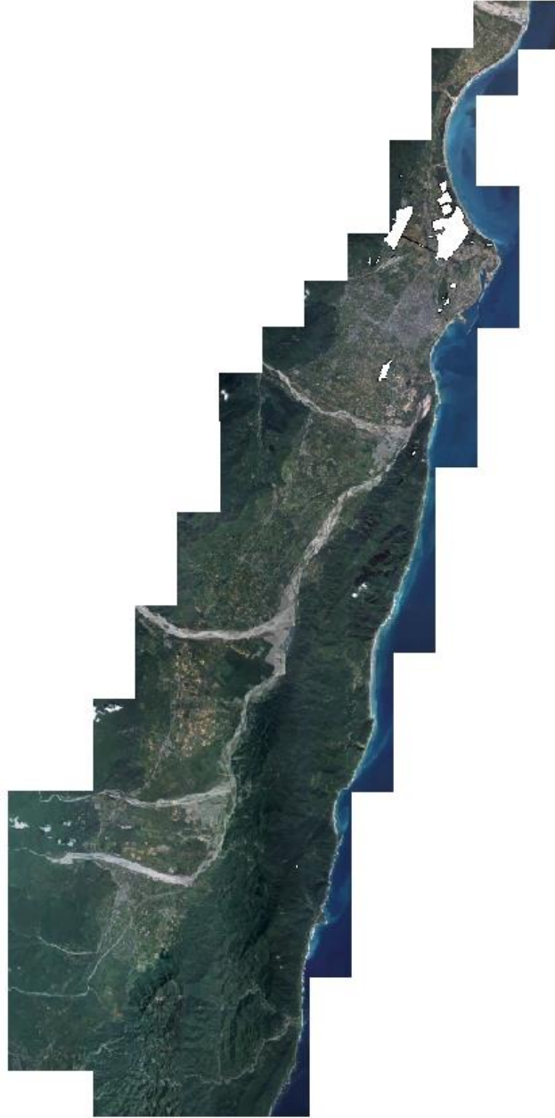
圖 2-28 110 年度花蓮地區正射影像無接縫影像拼接示意圖
