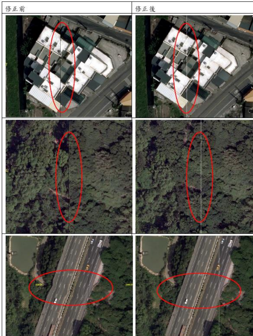
圖 3-4 正射影像接邊及變形自我檢核範例
