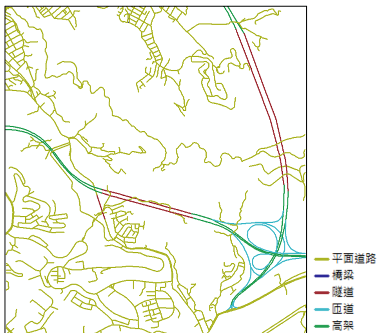
圖 2-3 道路中線依道路結構碼 (ROADSTRUCT) 分類
