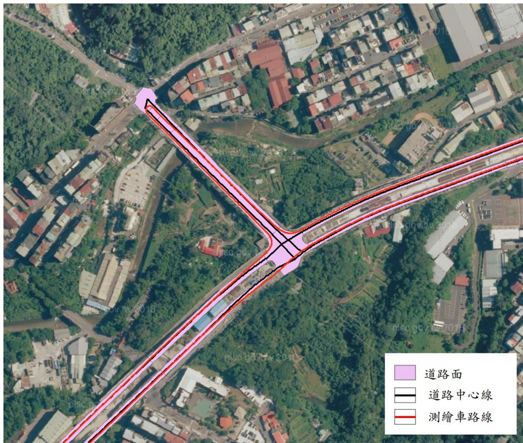
圖 2-35 使用測繪車高程資料獲取中線高程
