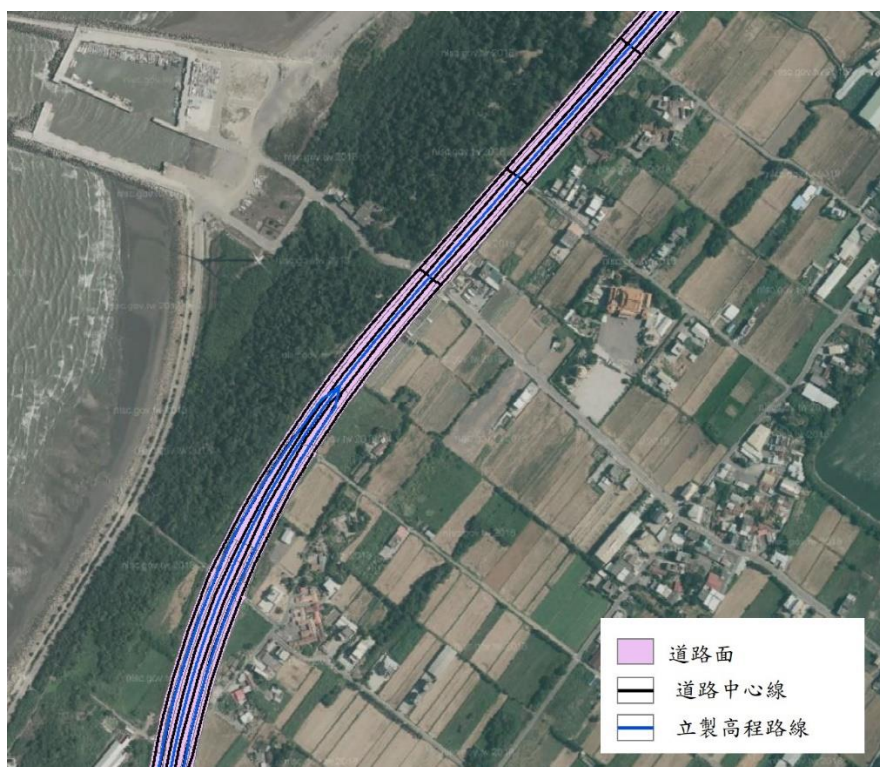
圖 2-37 使用立體製圖高程資料獲取中線高程
