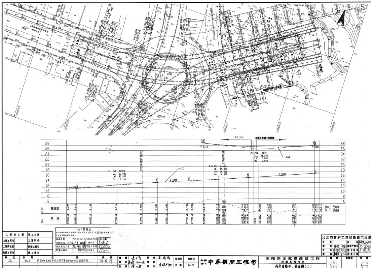
圖 2-31 環東快速道路竣工圖
