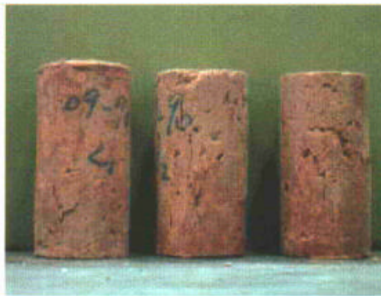
照片 8.1 三合土+水泥 (0.4) 90 天齡期抗壓試驗試體變化情況
