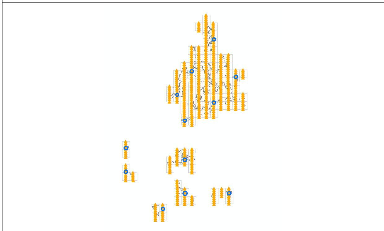
圖 4-2-7-2-12、第 2 作業區澎湖投影中心分布 (藍圈為空三模型查核處)
