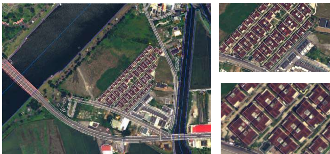
圖 4.6-4 正射影像套疊向量檔成果範例
