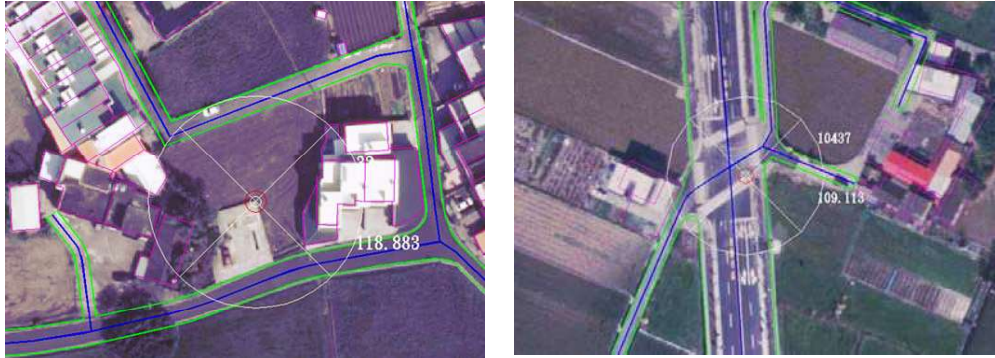
圖 4.6-5 以航測特徵點檢核正射影像範例
