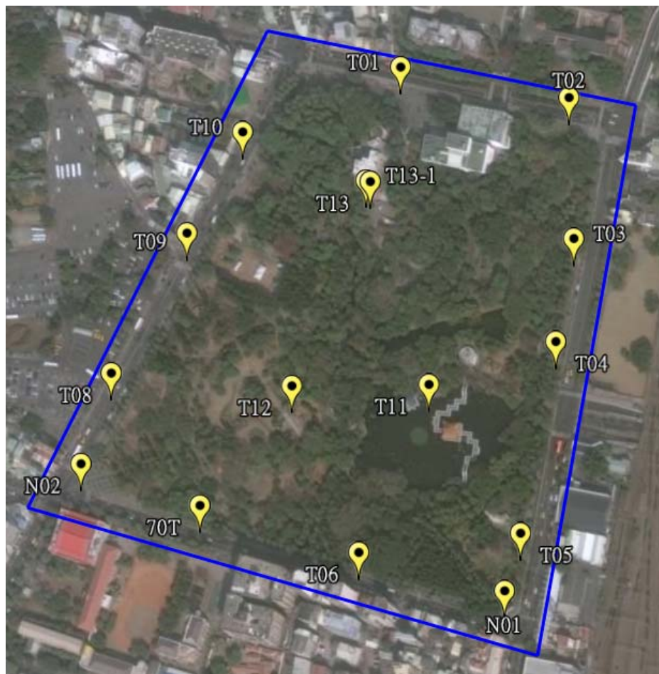
圖 4-8 台南公園地面控制場
