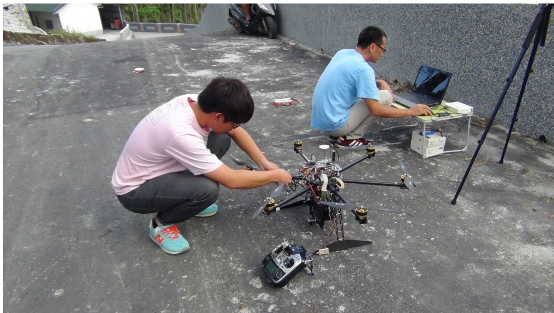
圖 3-3 起降場地瑞北村馬路旁架設多旋翼型 UAS 及導航裝備
