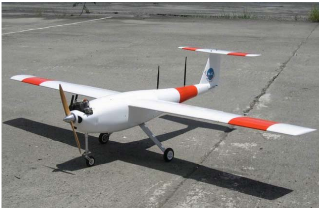
圖 2-2 國土測繪一號定翼型 UAS
