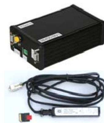
圖 3-4 (a)輕量化的資料記錄器模組 (b)三軸磁力計與記憶卡 (Johannes B. Stoll, 2013)
