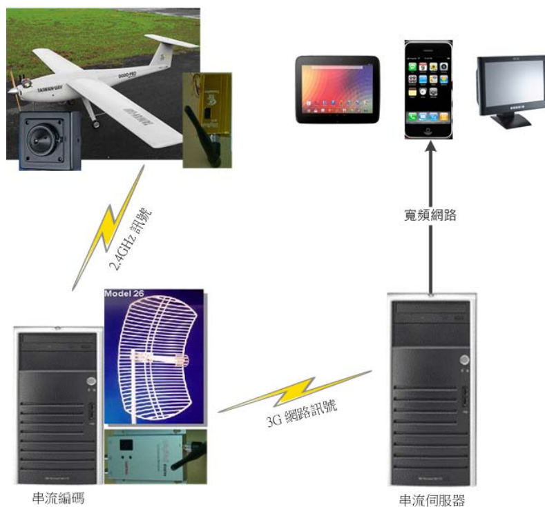
圖 6-5 類比即時影像傳輸架構圖
