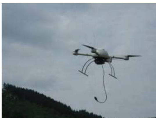
圖 3-3 以電動四旋翼 UAS (md4-1000 microdrones, Germany) 搭載磁力計 (Johannes B. Stoll, 2013)
