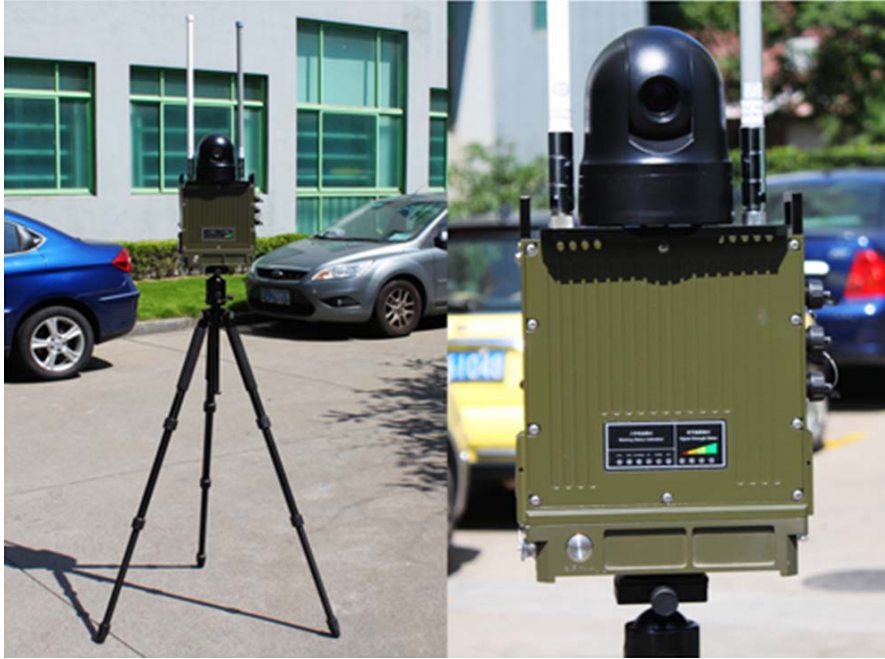
圖 6-6 地面數位通訊設備架設圖 (使用全向天線)
