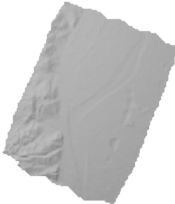
圖 6-18 自動匹配 50 公尺*50 公尺的 DTM
