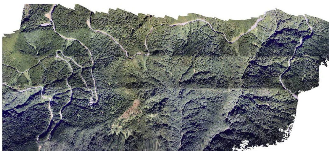
圖 6-105 DTM Grid Size 5m Grid Size 50 公分的幾何正射糾正鑲嵌圖
