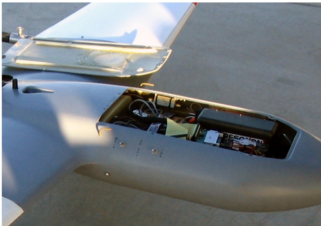
圖 3-36 空載高光譜儀裝備於 Manta UAV 上
