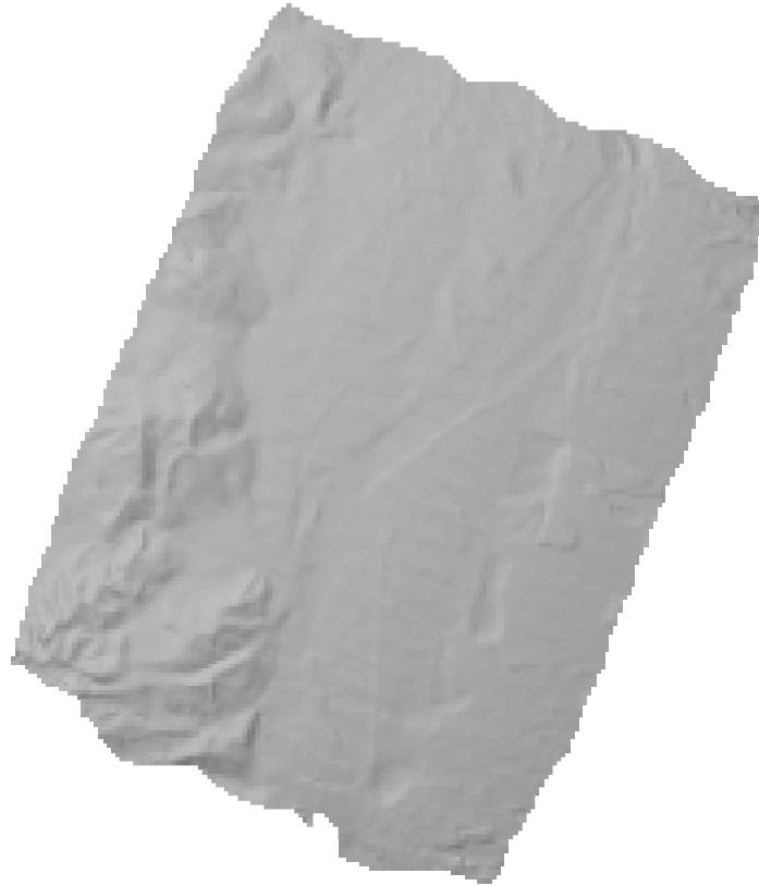
圖 6-17 自動匹配 25 公尺*25 公尺的 DTM
