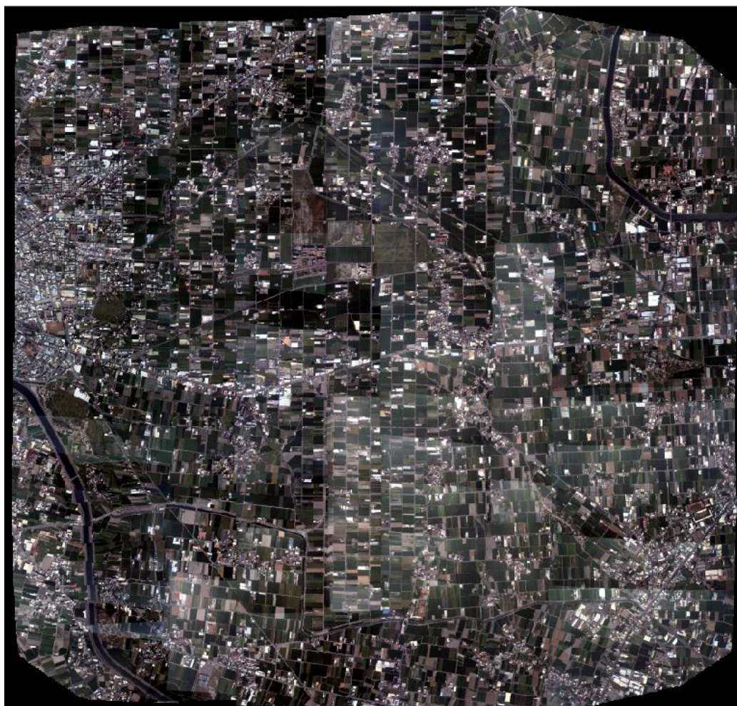
圖 6-31 Grid Size 25m、Cell Size 15 公分的幾何正射糾正鑲嵌圖
