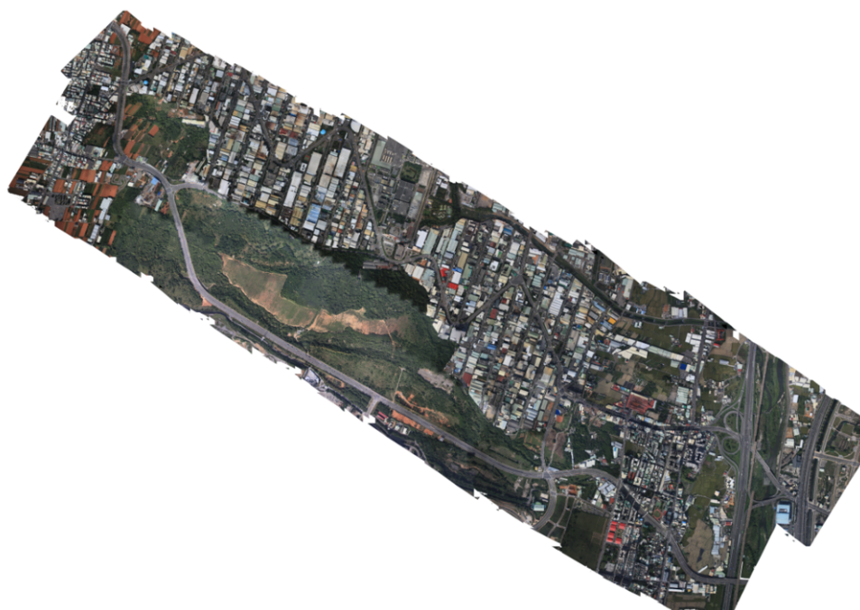
圖 6-47 Grid Size 25 公尺、Cell Size 25 公分的幾何正射糾正鑲嵌圖
