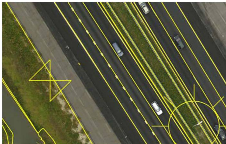
圖 3-19 三維向量資料套合正射影像
