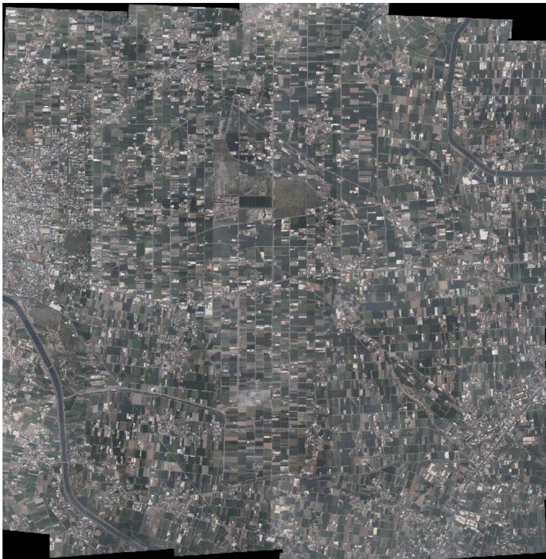
圖 6-96 Grid Size 5 公尺 DTM、Cell Size 25 公分正射鑲嵌圖
