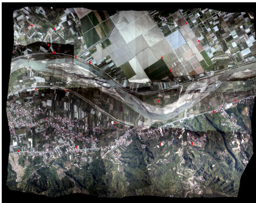
圖 6-78 正射鑲嵌檢核點分布圖
