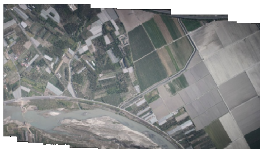
圖 6-6 航帶像片數為 32 張的錯誤接合成果圖示
