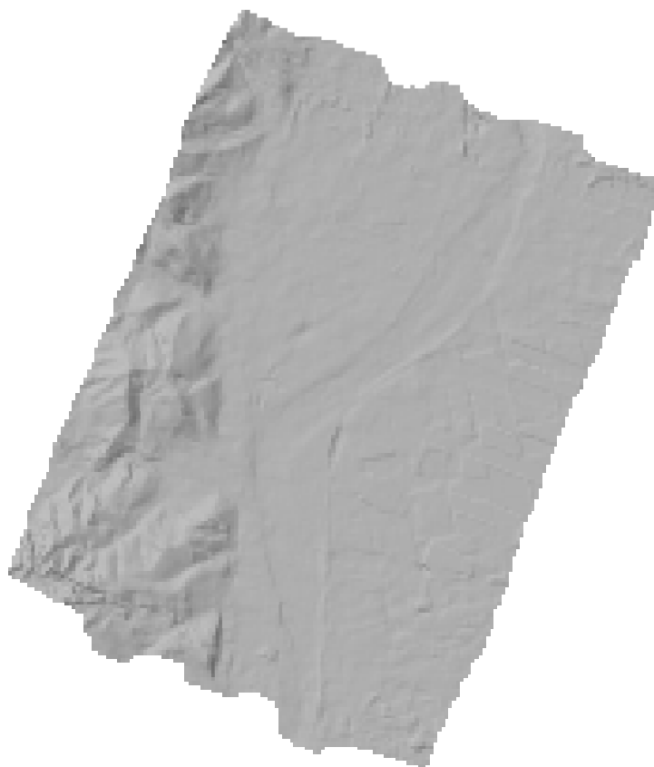
圖 6-75 Cell Size 5 公尺之 DTM
