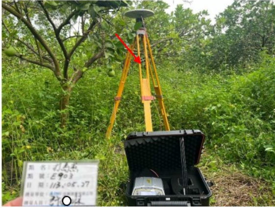
圖 2-10 信號線纏繞於腳架上
