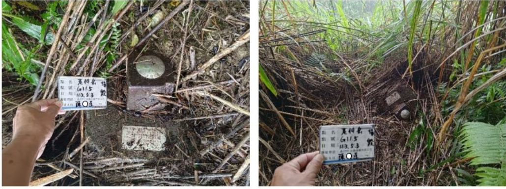
圖 2-2 基本控制點 G115 損毀
