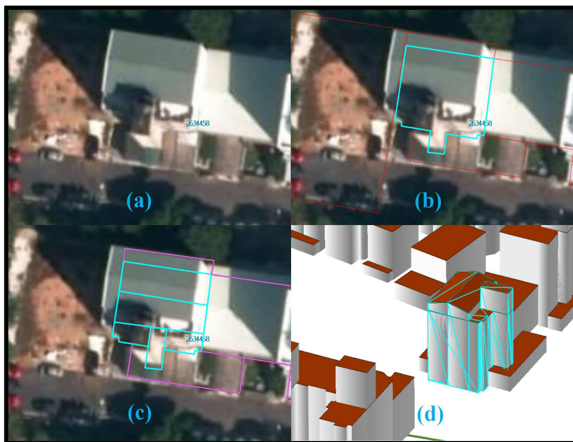
圖 2-19 屋頂結構面組成 LOD2 建物框示意圖
