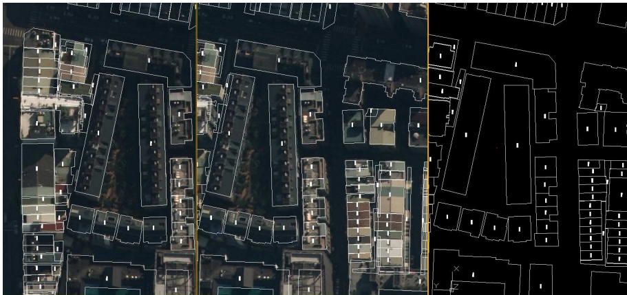
圖 2-53 三維房屋模型幾何框架投影至影像協助幾何品質檢核作業
