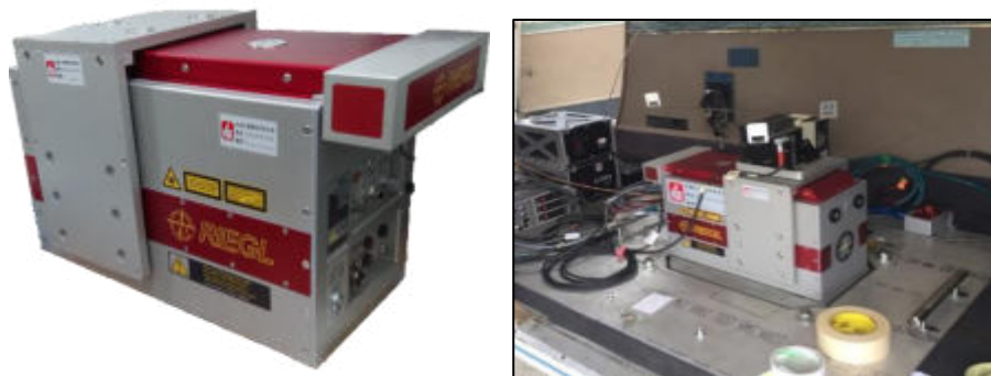
圖 2-2 空載光達 Riegl LMS-Q780 實機照
