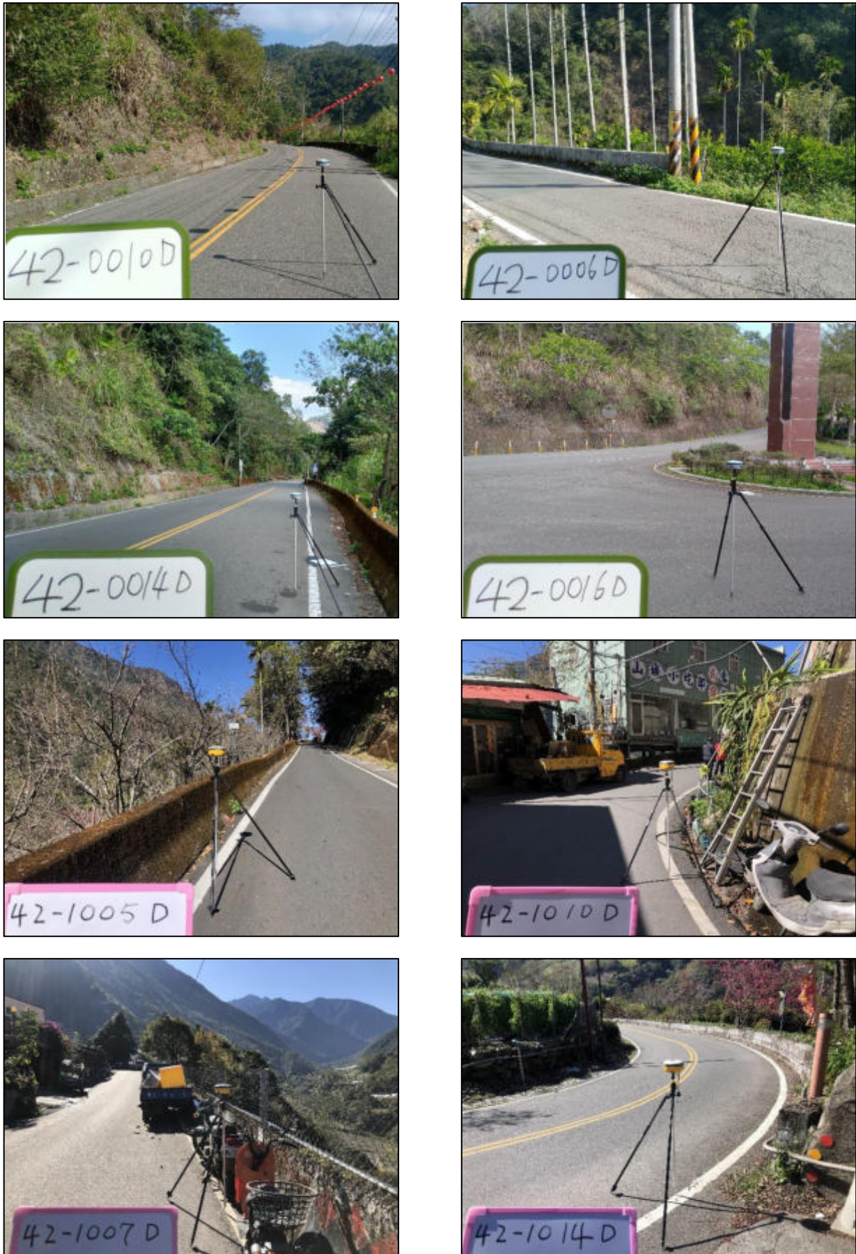
圖 2-27 橫斷面檢核點現場作業工作照
