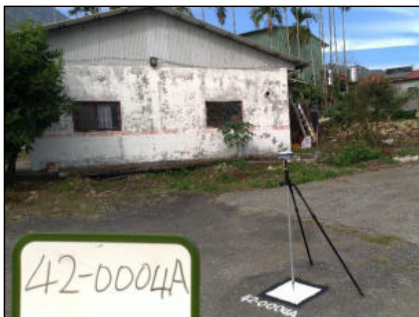
圖 2-6 地面 GNSS 衛星定位儀實際作業照
