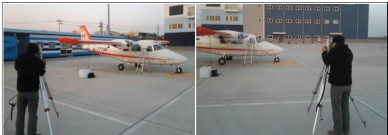
圖 2-13 Lever arm 量測作業照
