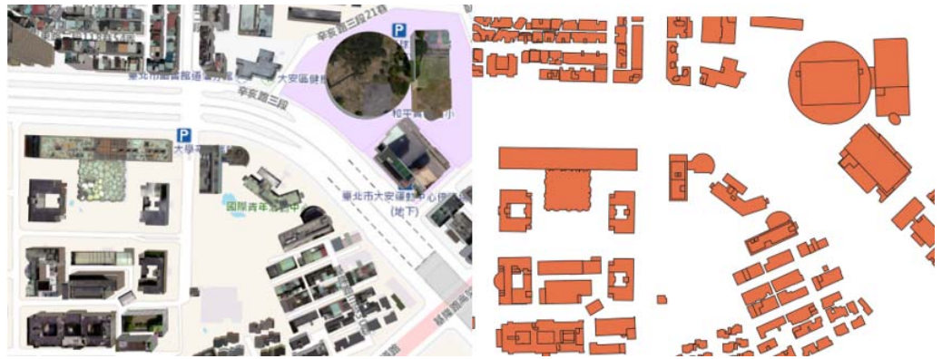
(b)近似模型萃取建物外型 SHP 示意圖
