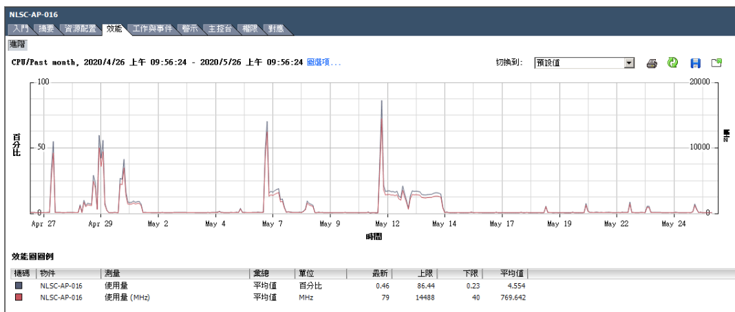
圖 3- 63 國網中心 VM 之 CPU 效能監控數據示意圖
