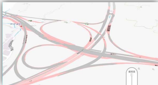
圖 4-21 高架道路(絕對高度)與地形衝突示意圖
