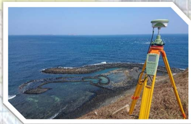
圖 3 -11 辦理加密控制測量作業情形
