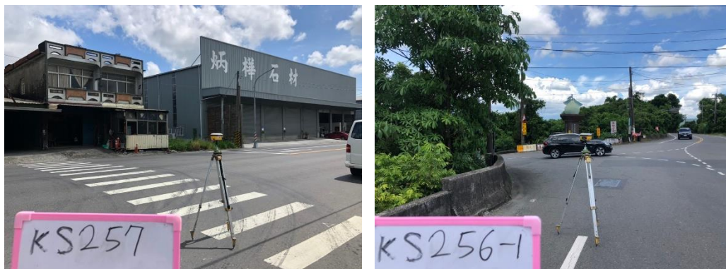
圖 3-4、VBS-RTK 補充測量計畫範圍特徵點作業
