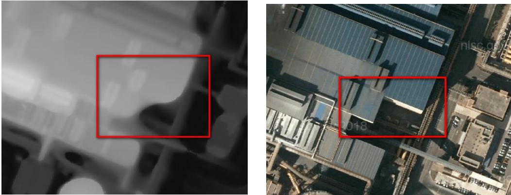
圖 4-65、密匹配成果 DSM 邊緣平滑化現象對比
