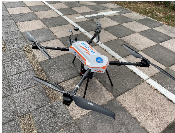
圖 4-1 遙控無人機外型及籌載整合情形
