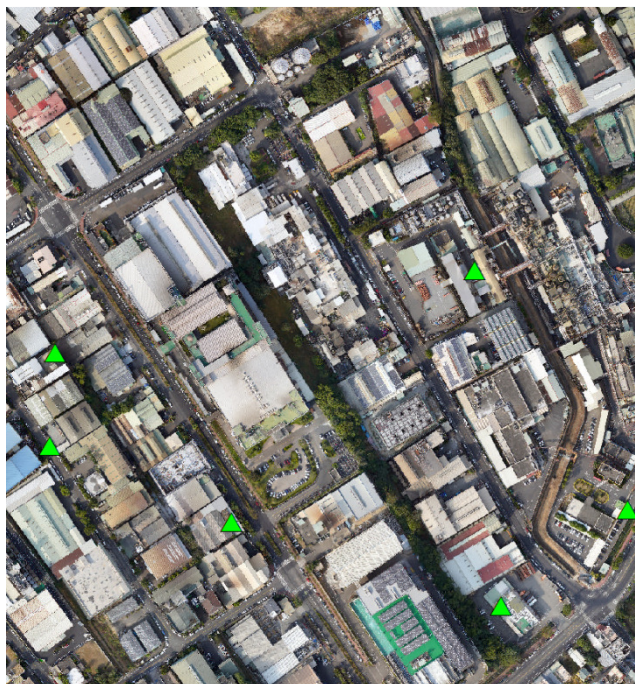
圖 4-30 南崗校正場(離地高 150 公尺)檢核點分布位置
