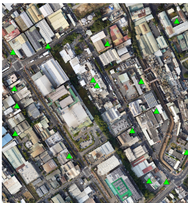
圖 4-24 南崗校正場航拍檢核點分布圖
