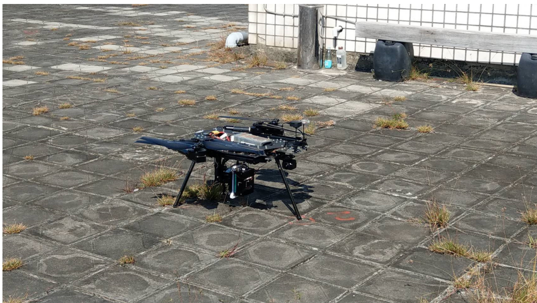
圖 4-10 定位定向系統單點定位精度實測資料蒐集情形
