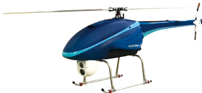
圖 2-3 單旋翼型 UAS
