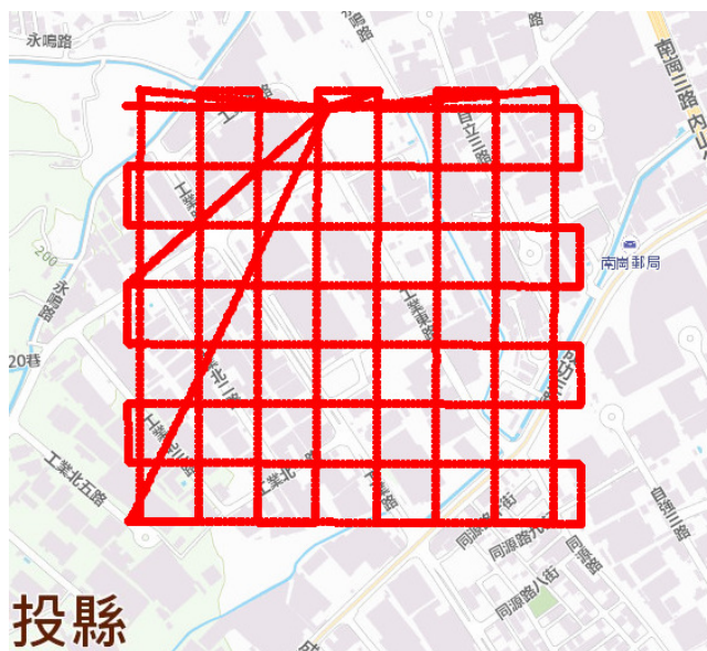
圖 4-27 南崗校正場航拍(離地高 150 公尺) POS 軌跡
