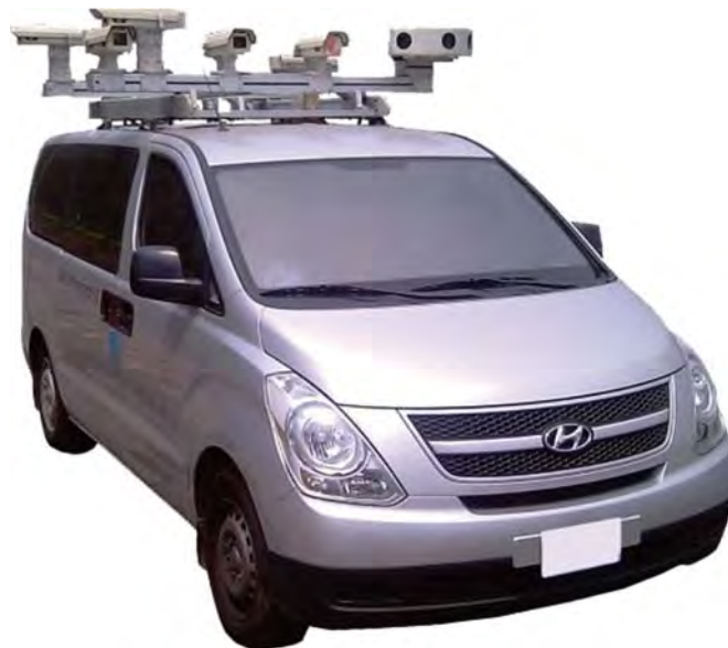
圖 2-19 日陞空間資訊車載移動測繪系統(摘自 http://www.srgeo.com.tw/ )
