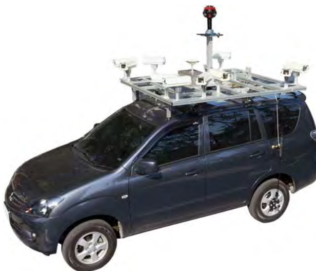
圖 2-20 經緯航太科技第一代車載影像式移動測繪系統(摘自 http://www.geosat.com.tw/ )
