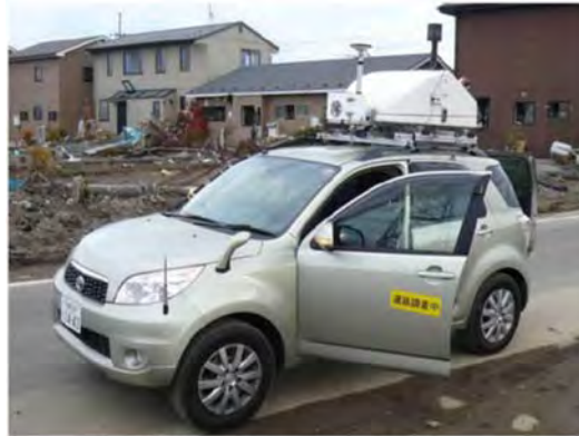
圖 2-46 Asia Air Survey 車載移動測繪系統 GeoMasterNeo(摘自 Hatake et al., 2011)
