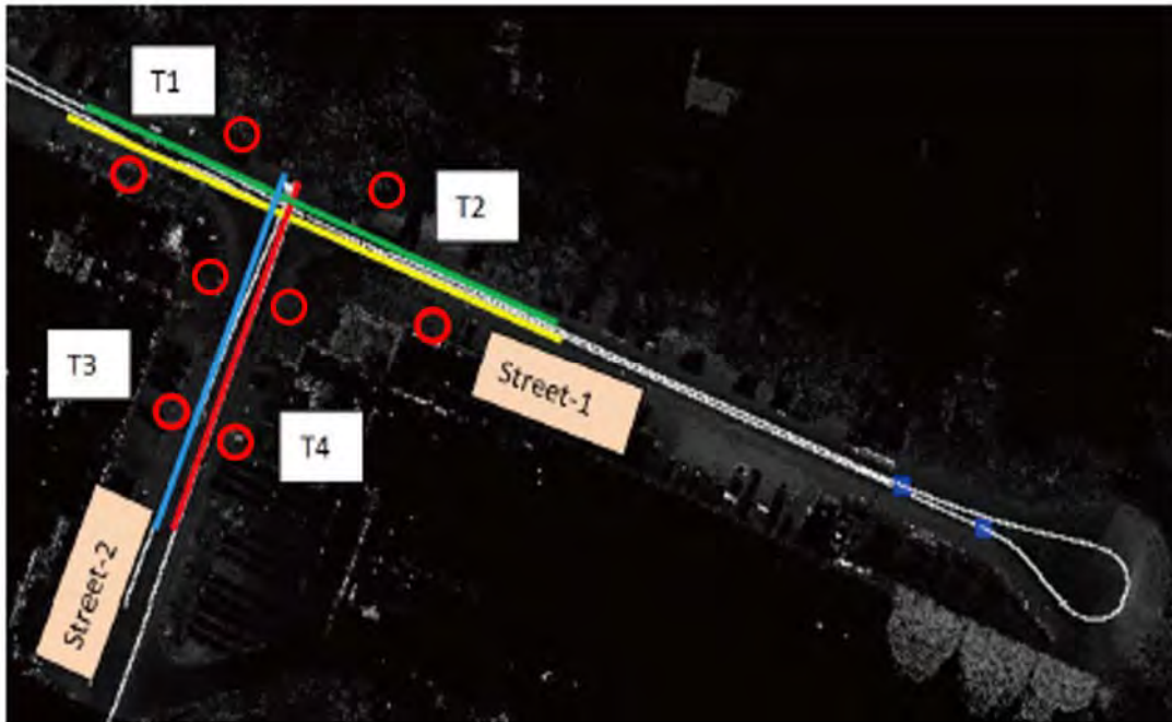
圖 2-58 Z+F 軸角/固定臂率定場作業模式示意圖(摘自 http://www.zf-laser.com/ )
