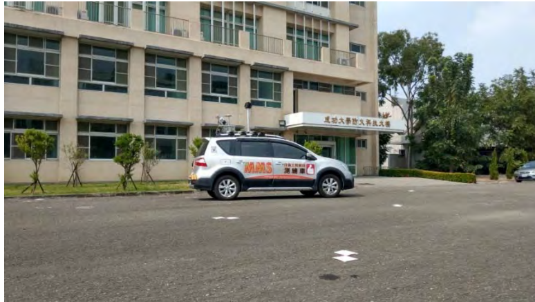
圖 3-94 自強工程顧問有限公司車載光達系統率定作業情形
