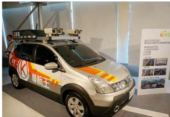
圖 2-10 勤崑國際科技車載影像式移動測繪系統(摘自 http://www.kingwaytek.com/ )
