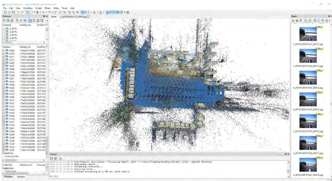
圖 3-106 國土測繪中心車載影像式系統率定作業空三成果
