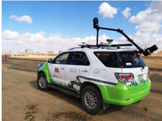
圖 2-50 IWANE 車載移動測繪系統(摘自 http://www.iwane.com/ )
