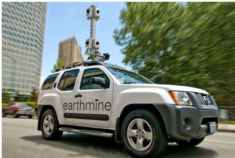
圖 2-42 Earthmine 車載移動測繪系統(摘自 http://www.nokia.com/ )
