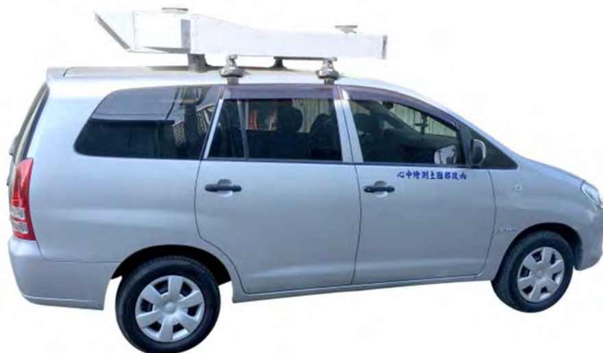
圖 2-1 國土測繪中心建置之車載影像式移動測繪系統
