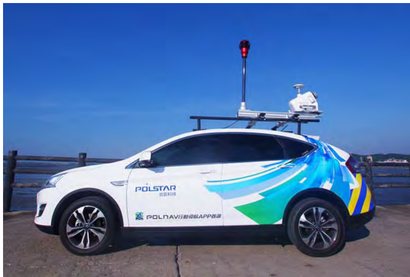
圖 2-15 北宸科技車載移動測繪系統(摘自 http://www.polstargps.com/ )
