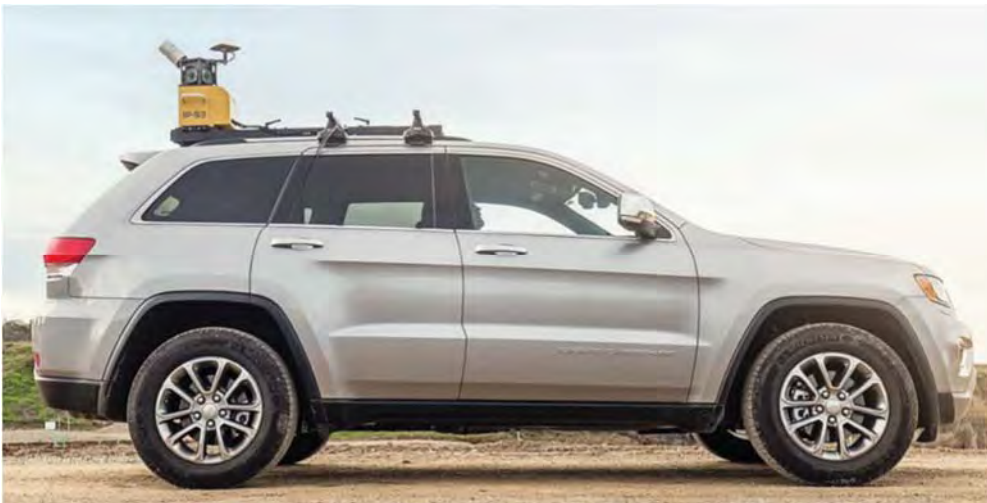
圖 2-37 TOPCON 車載移動測繪系統(摘自 http://www.topconpositioning.com/ )
