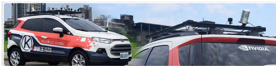
圖 2-11 勤崑國際科技車載光達式移動測繪系統(摘自 http://www.kingwaytek.com/ )
