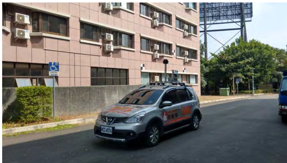
圖 3-97 自強工程顧問有限公司車載光達系統檢核作業情形
