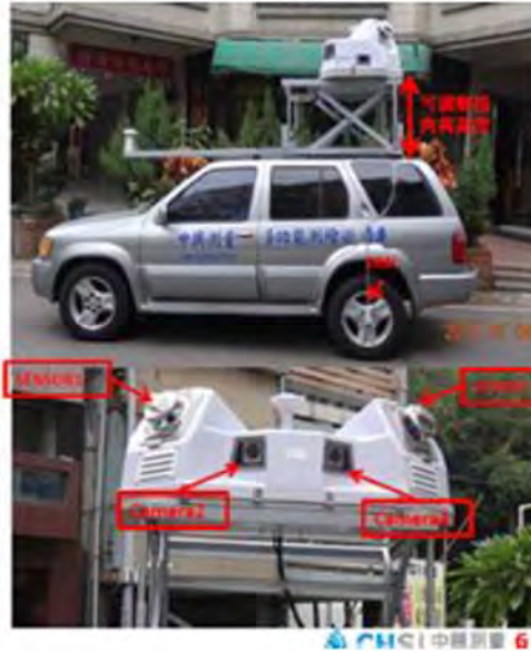
圖 2-18 中興測量車載移動測繪系統(摘自 http://www.chsurvey.com.tw/ )
