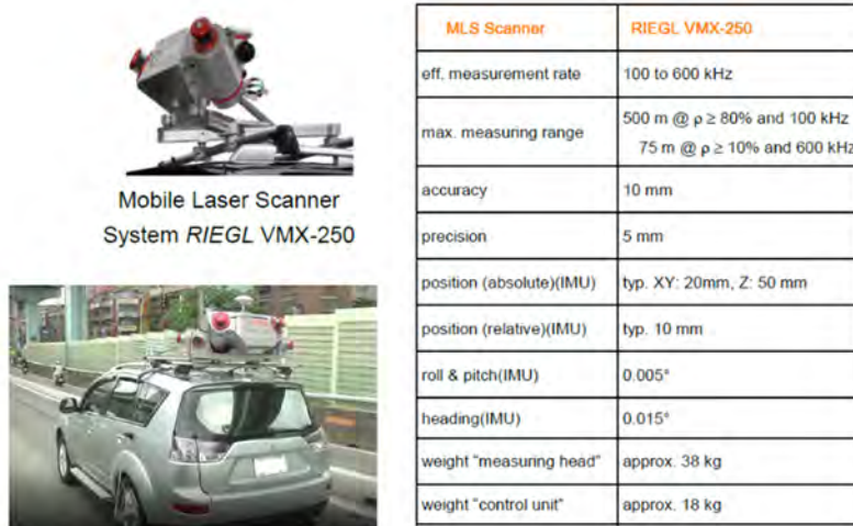
圖 2-9 詮華國土測繪車載移動測繪系統(摘自 http://www.chuanhwa.com.tw/ )
