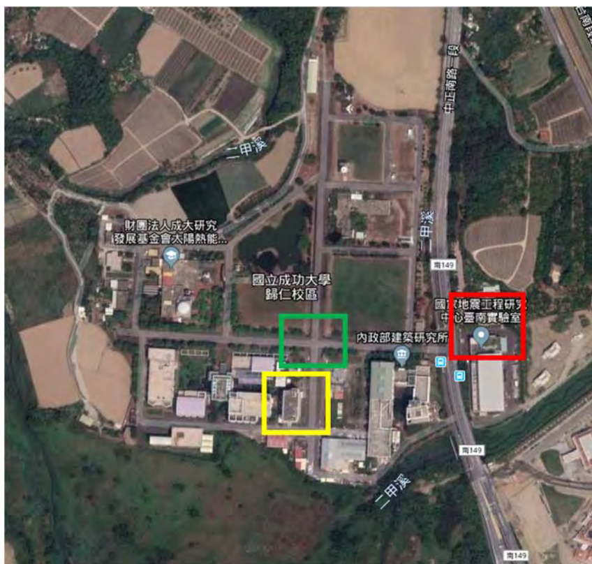
圖 3-83 光達系統(黃框)率定場 1；(綠框)率定場 2；(紅框)檢核場範圍
