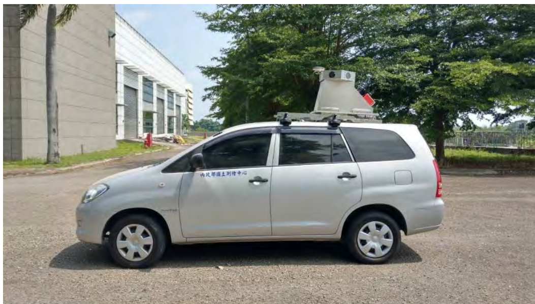
圖 2-2 國土測繪中心建置之車載光達式移動測繪系統
