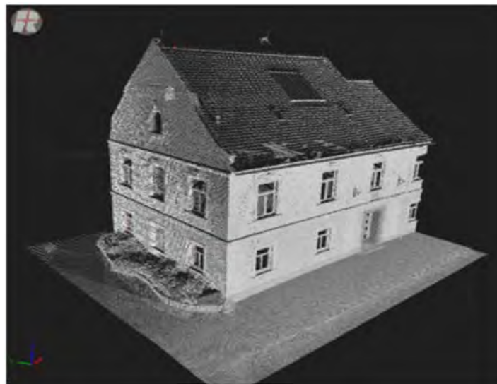
圖 2-33 車載光達掃描成果(摘自 http://www.riegl.com/ )
