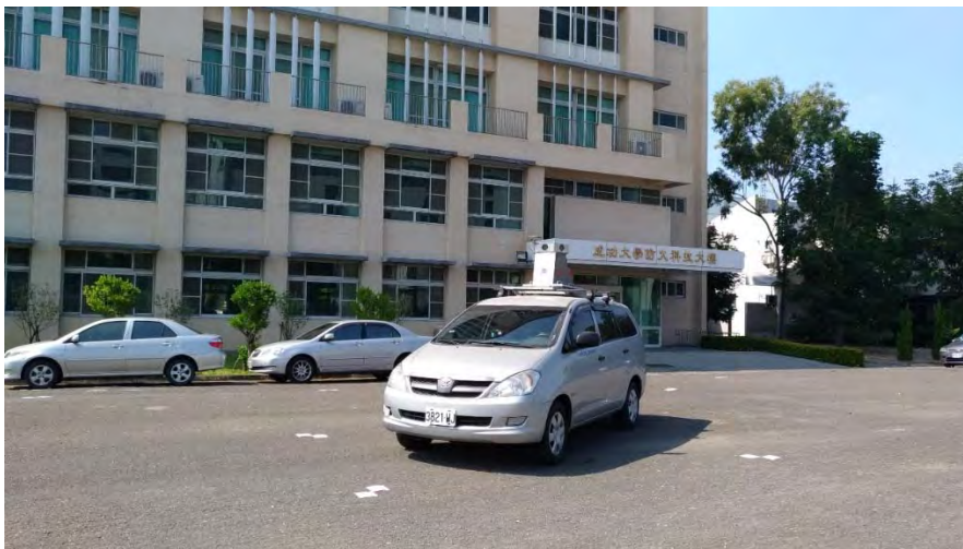
圖 3-86 國土測繪中心車載光達系統率定作業情形
