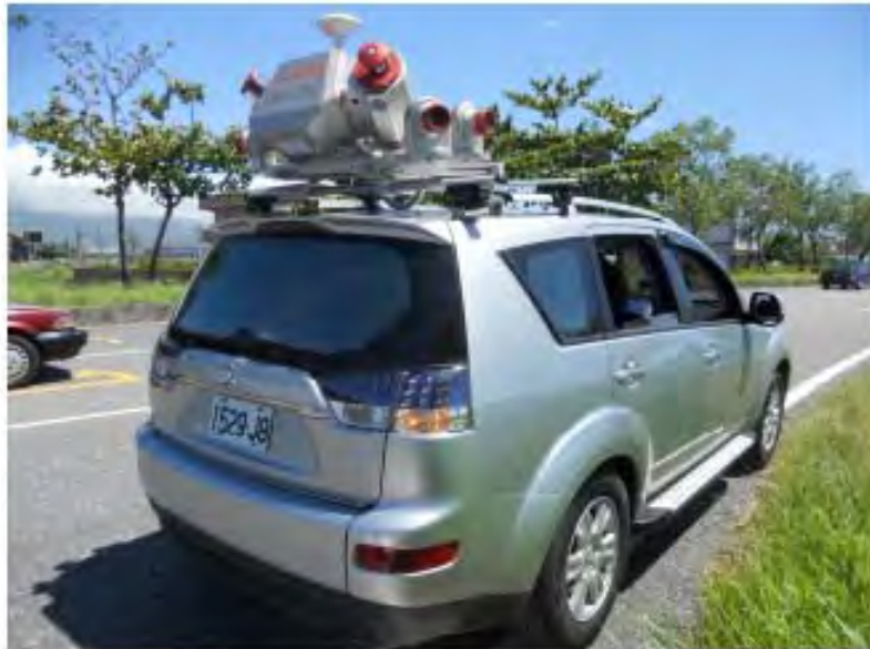
圖 2-32 RIEGL 車載移動測繪系統 VMX-250(摘自 http://www.riegl.com/ )
