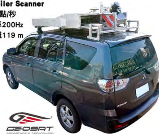
圖 2-22 經緯航太科技車載光達式移動測繪系統(摘自 http://www.geosat.com.tw/ )
