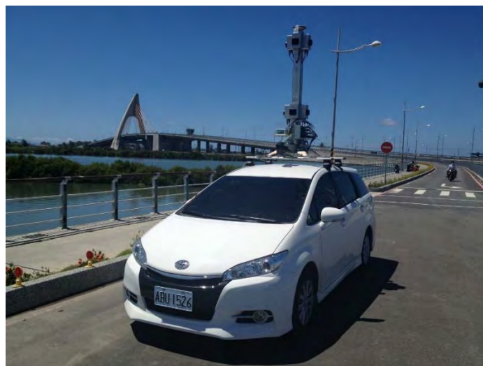
圖 2-12 群立科技車載移動測繪系統(摘自 http://www.geoforce.com.tw/ )
