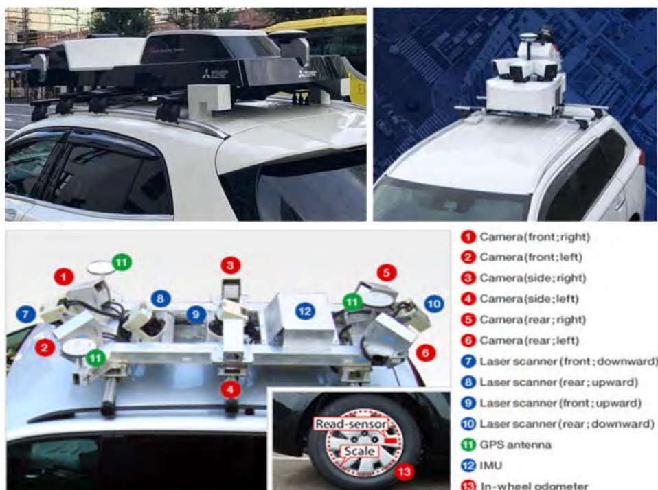
圖 2-45 三菱電機車載移動測繪系統(摘自 http://www.mitsubishielectric.com/bu/mms/ )
