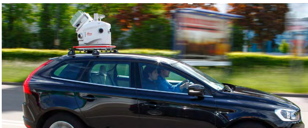
圖 2-38 LEICA 車載移動測繪系統(摘自 http://leica-geosystems.com/ )
