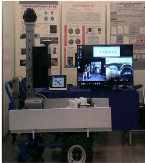
圖 2-6 國立成功大學推車式移動測繪系統
