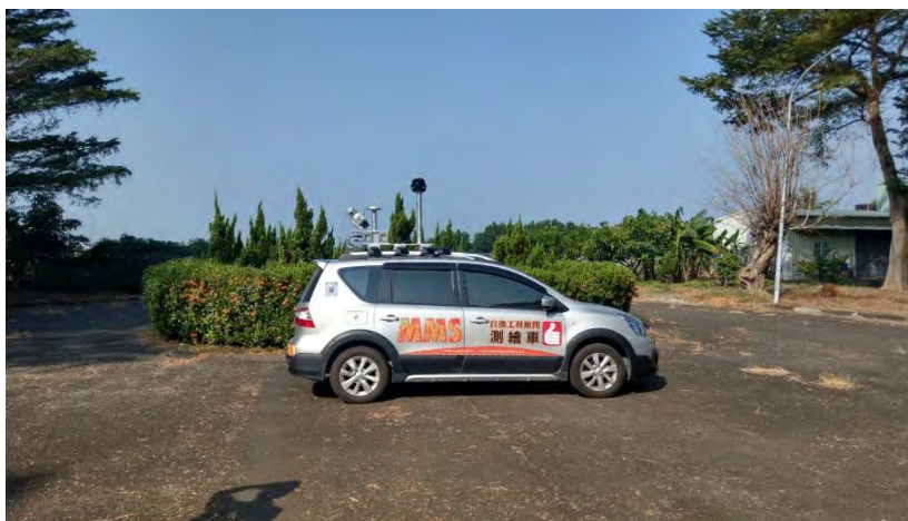
圖 3-107 自強工程顧問有限公司車載影像式系統率定作業情形
