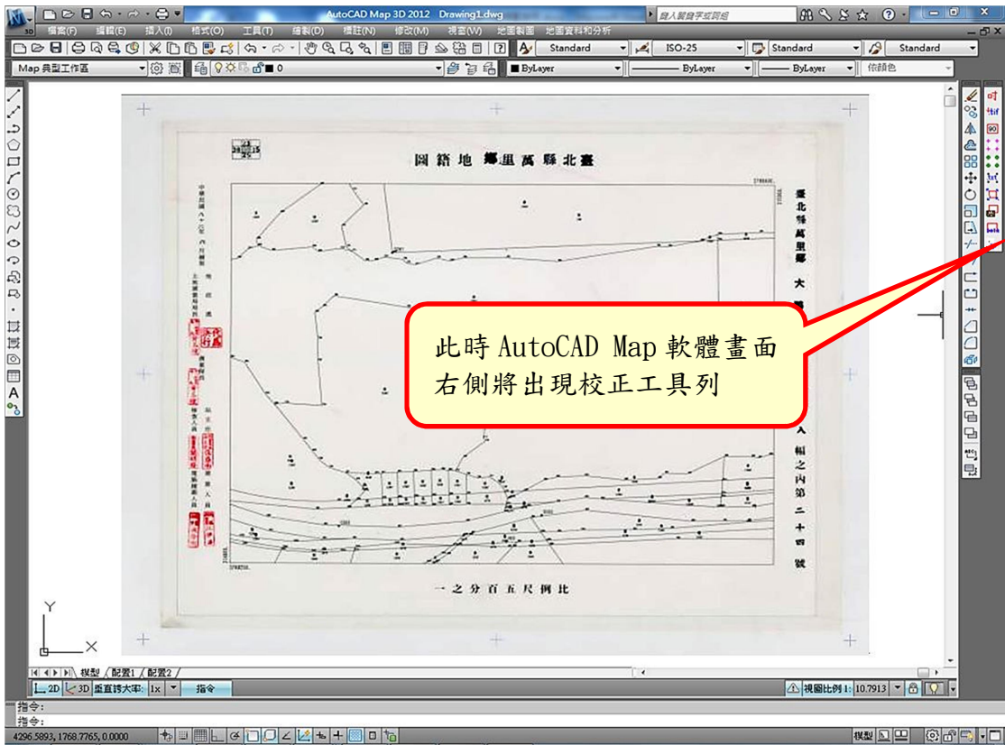
圖 3-9 地籍原圖掃描影像成果幾何校正工具畫面
