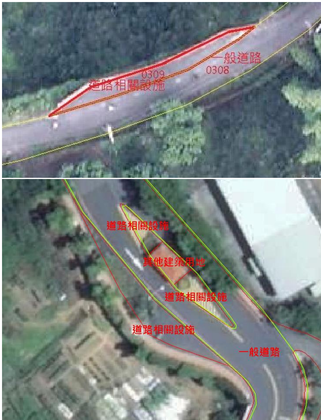
圖 3-8、避車彎及槽化線
