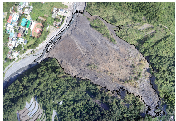
圖 3-58 第 2 次作業之影像分類崩塌範圍 (NDWI)
