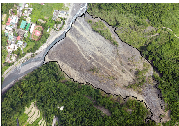
圖 3-53 第 1 次作業之影像分類崩塌範圍 (NDVI)
