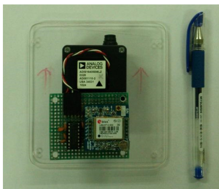
圖 3-17 六旋翼型 UAS POS 原型設計
