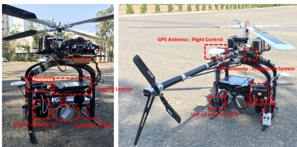
圖 2-11 無人直升機搭載光達及 GNSS/INS(G. J. Tsai, 2017)
