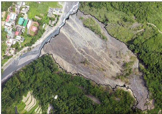
圖 3-57 第 1 次作業之影像分類崩塌範圍 (NDWI)
