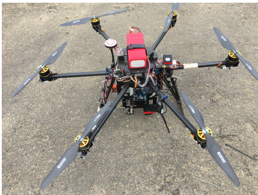
圖 3-1 六旋翼型 UAS 整合多光譜感測器
