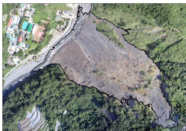
圖 3-54 第 2 次作業之影像分類崩塌範圍 (NDVI)
