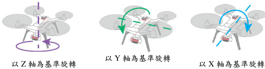
圖 3-25 系統姿態率定(摘自 Sequoia 使用手冊)
