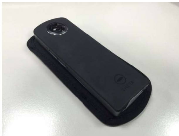
圖 2-38 RICOH THETA S 全景攝影設備
