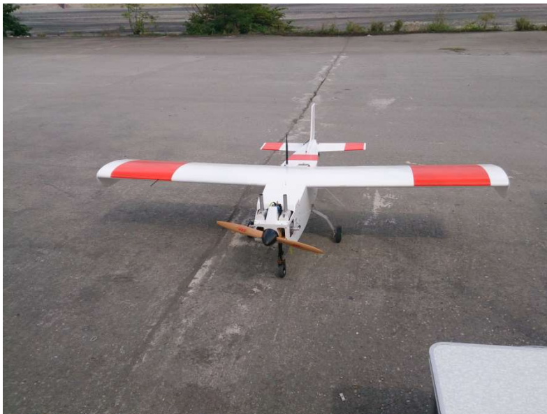
圖 2-1 國土測繪一號定翼型 UAS
