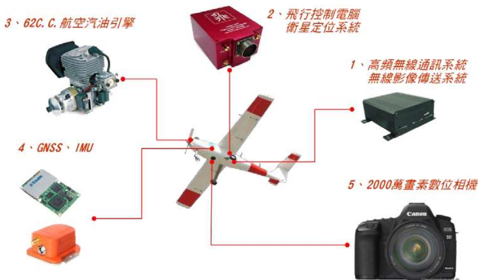
圖 2-2 國土測繪一號 UAS 系統架構
