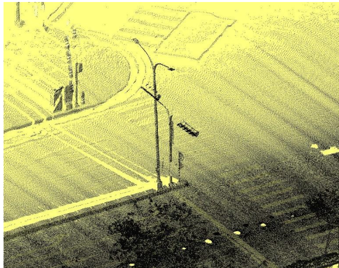
圖 6-11 往返點雲展示錯位修正後情形範例(非本次知高橋試辦案資料)
