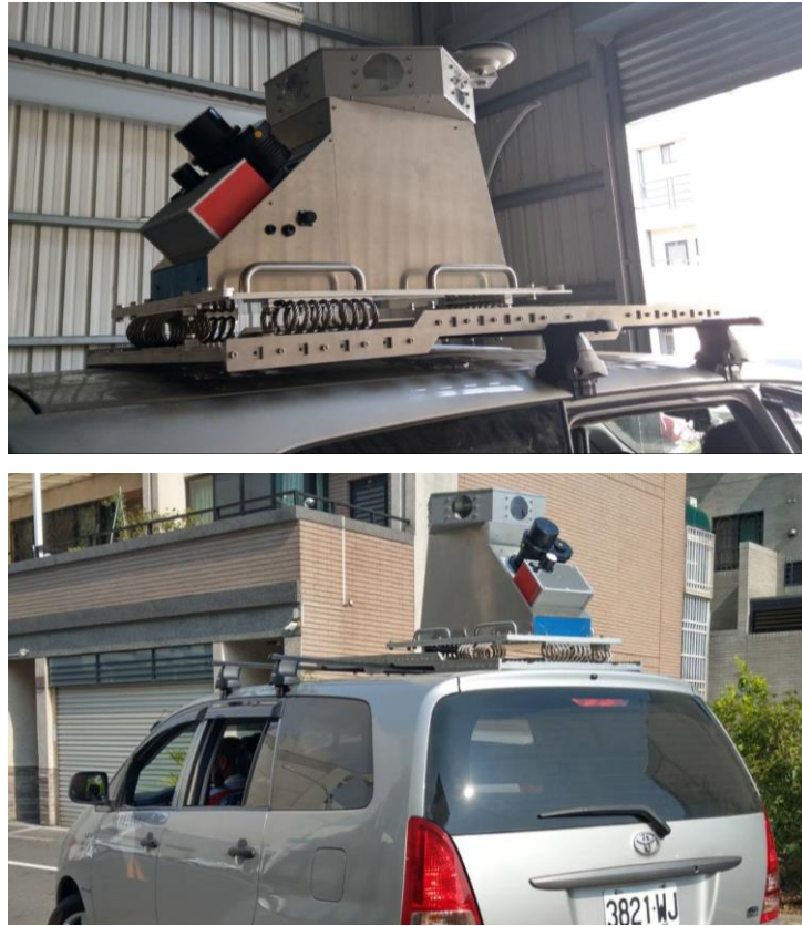
圖 3-35 車載光達移動測繪系統安裝情形
