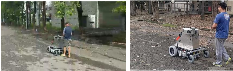
圖 5-72 推車式光達精度檢核作業情形
