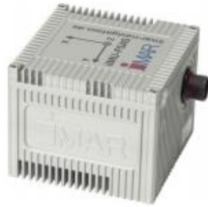
圖 3-6 選用之慣性量測元件
