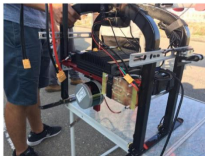
圖 2-6 光達整合系統
