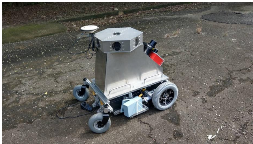
圖 3-43 推車式移動測繪系統配置組裝情形
