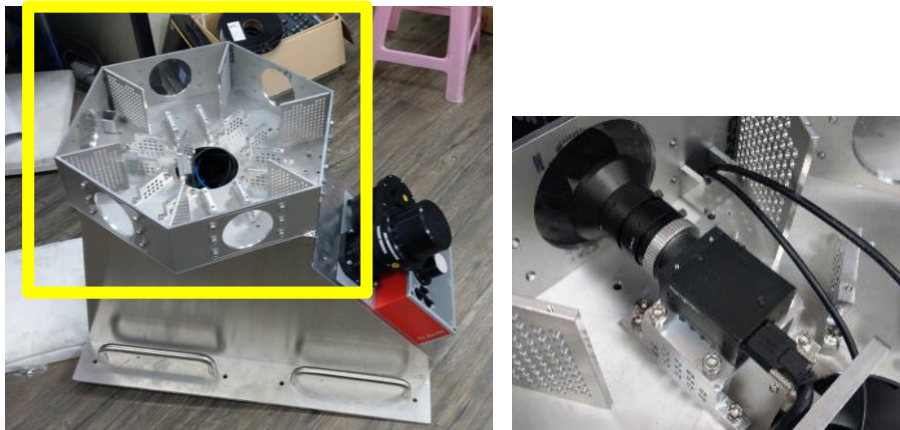
圖 3-32 環景相機系統架構尺寸及相機組裝情形
