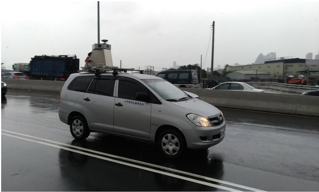
圖 6-2 試辦光達道路圖資更新作業外業情形
