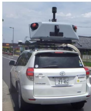
圖 2-26 MX-8 車載移動測繪系統(摘自 Takahashi et al., 2016)
