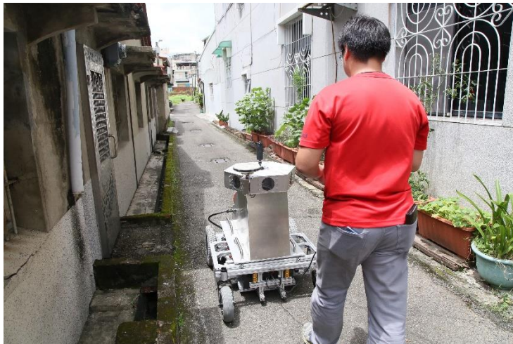
圖 6-35 推車式載具於狹小巷弄外業情形
