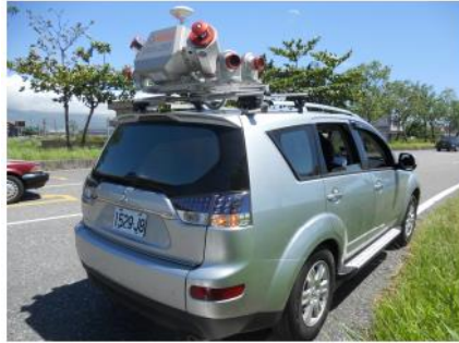
圖 2-11 VMX-250 車載移動測繪系統(摘自 http://www.riegl.com/ )
