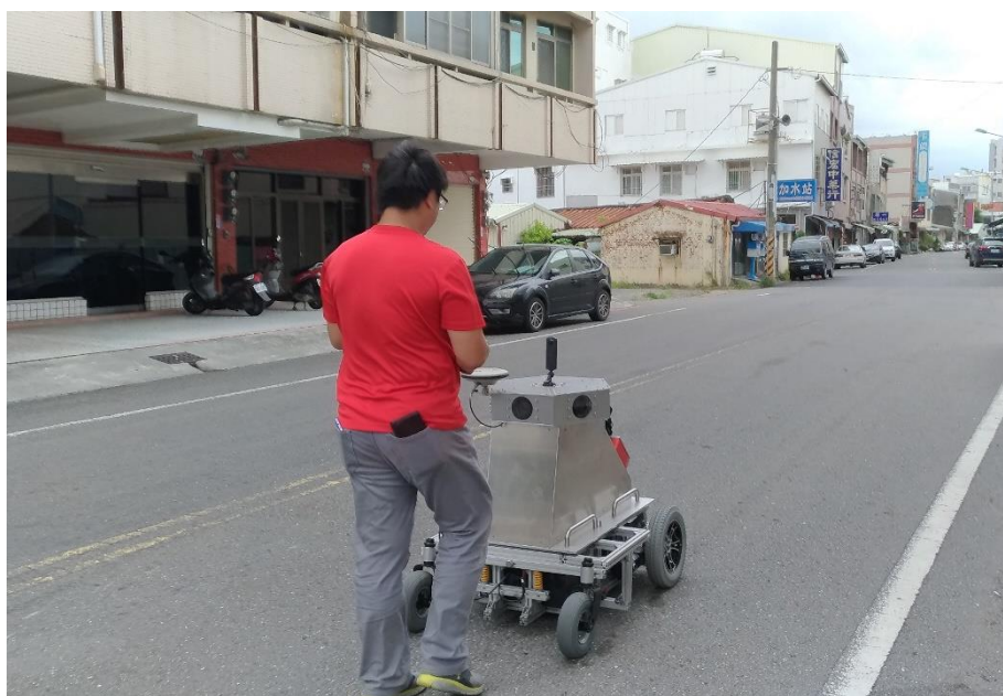
圖 6-17 試辦法院鑑測區光達資料蒐集作業外業情形
