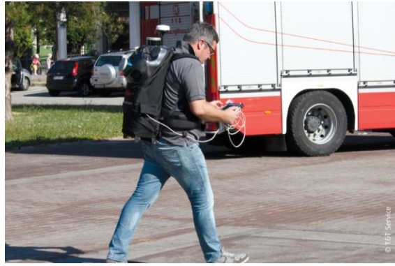
圖 2-31 Leica 可攜式光達背包系統(摘自 http://leica-geosystems.com )
