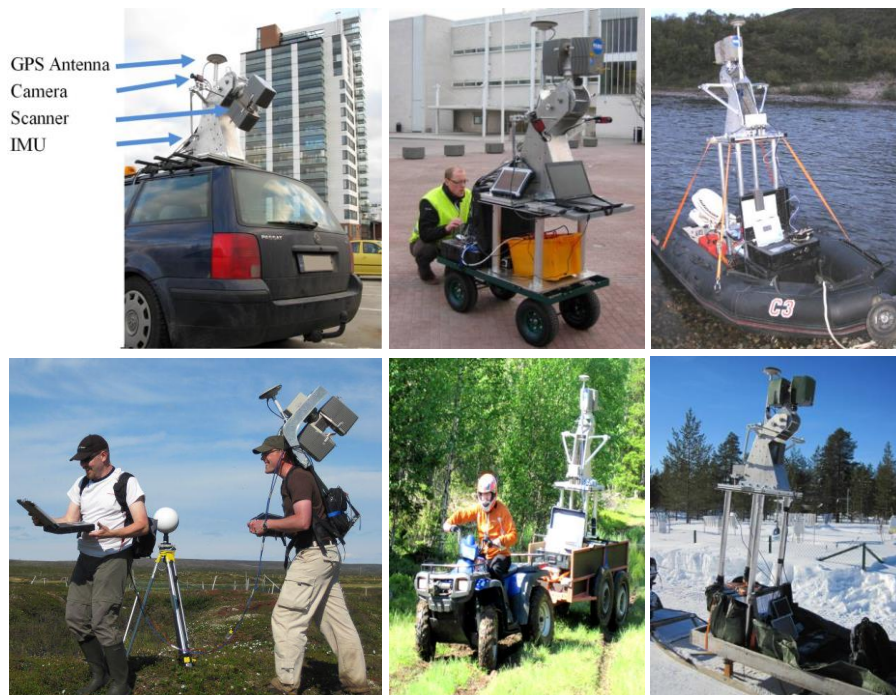
圖 2-29 移動測繪系統(摘自 Kukko et.al., 2012)
