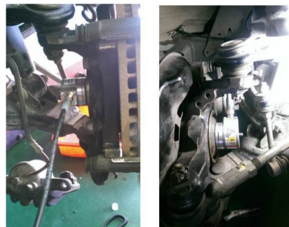
圖 3-8 輪速計安裝情形
