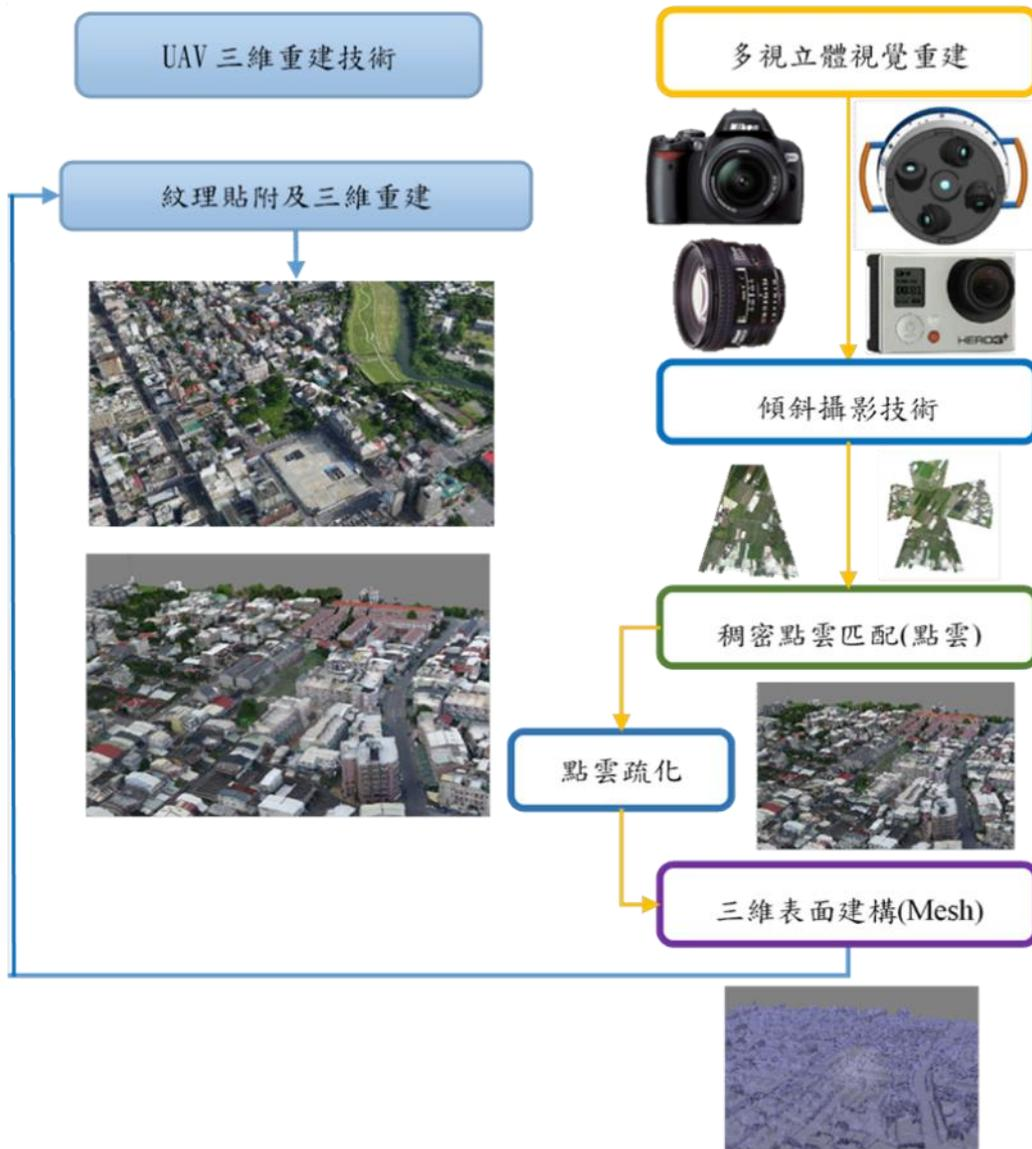
圖 4-4 UAS 三維建模技術與流程
