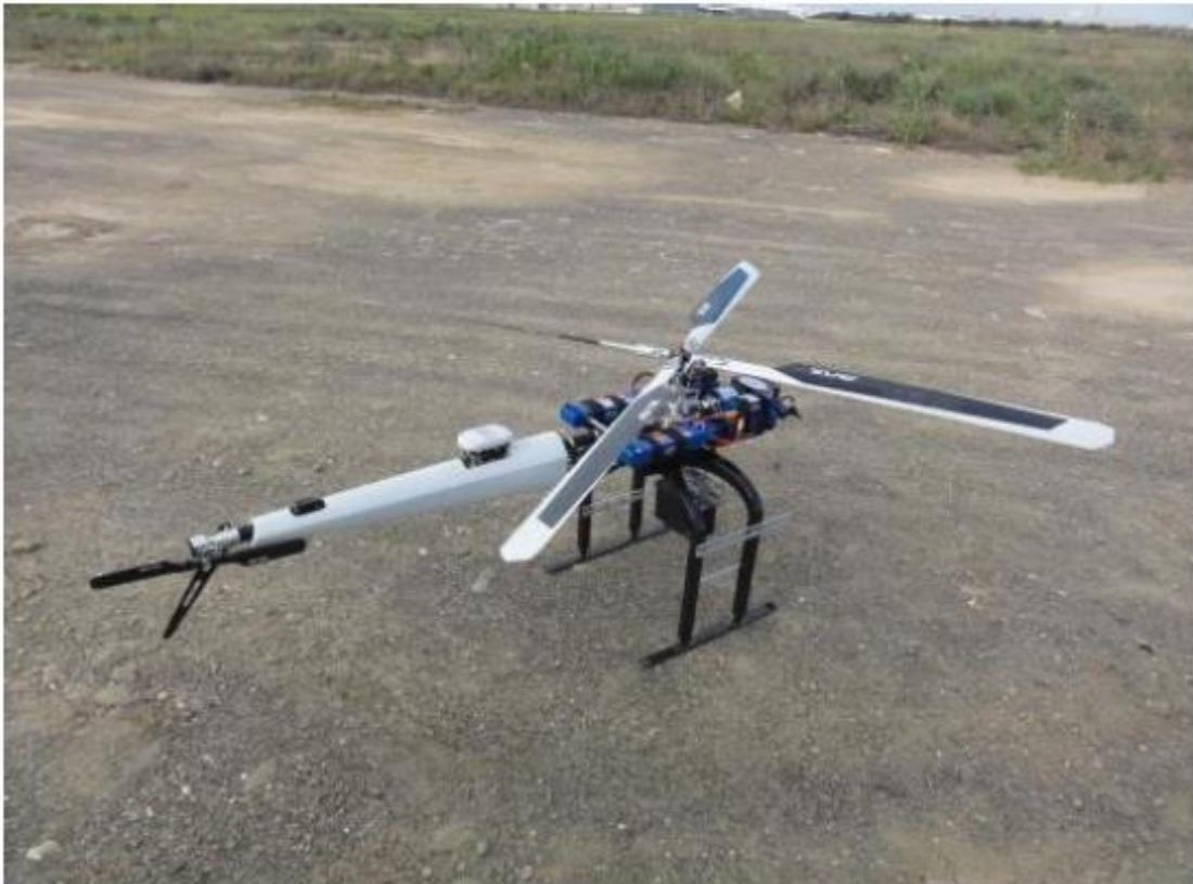
圖 5-4 單旋翼型 UAS
