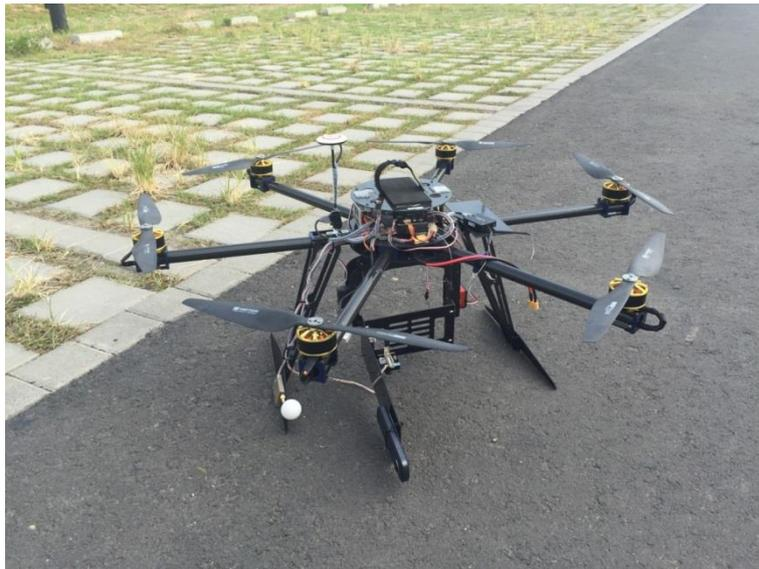
圖 4-37 旋翼型 UAS 與全景攝影設備
