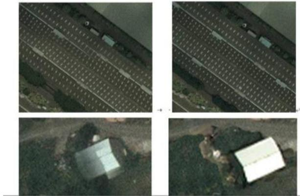
圖 2-30 正射影像編修前後比較（左：編修前、右：編修後）
