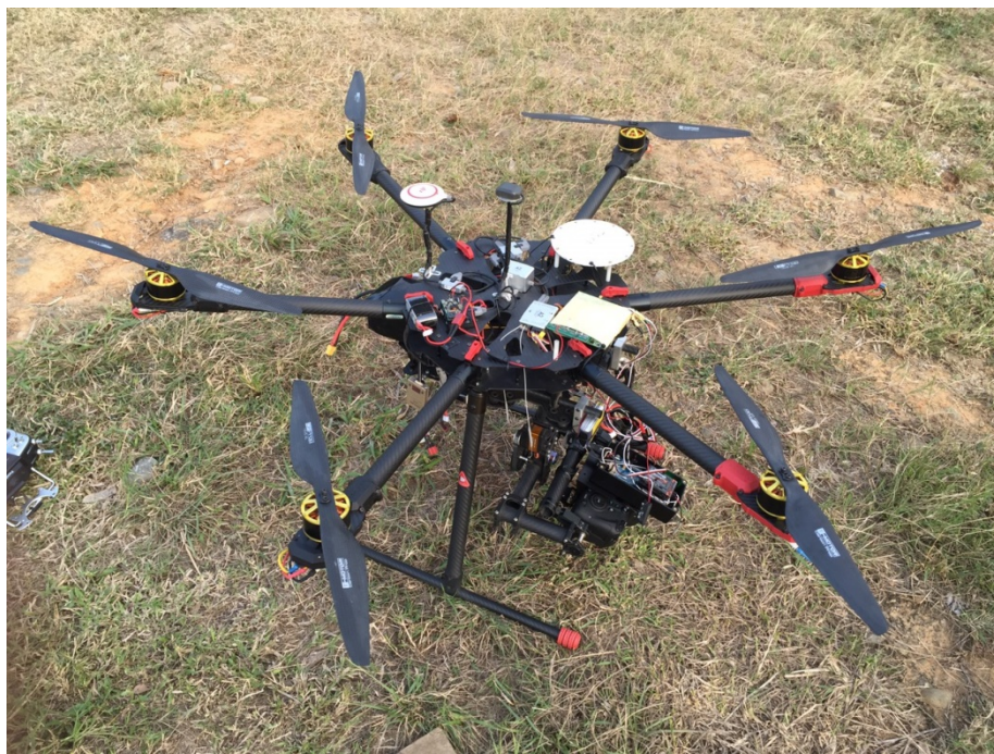
圖 5-38 旋翼型 UAS 及 GNSS/IMU 機電整合模組
