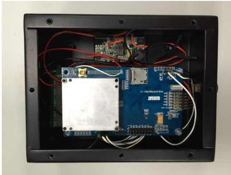
圖 5-16 系統整合硬體-電子電路整合外殼
