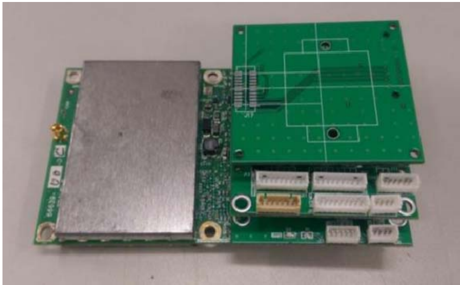
圖 5-13 直接地理定位模組電路板空間架構示意
