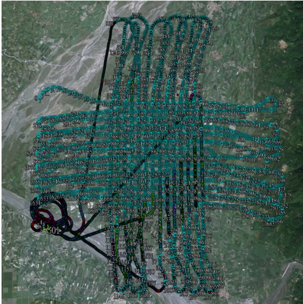
圖 5-35 整合 GNSS/IMU 之飛行軌跡
