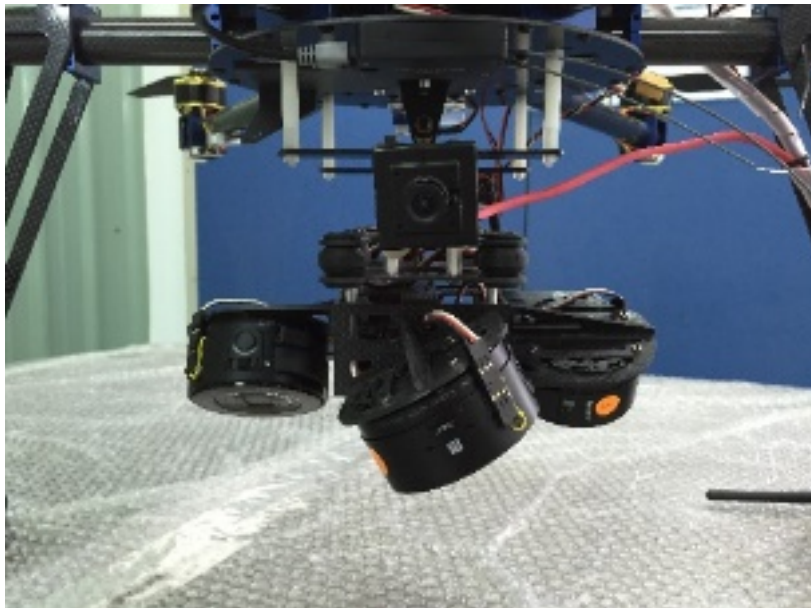
圖 6-4 無人飛行載具搭載自製多相機組合雲台
