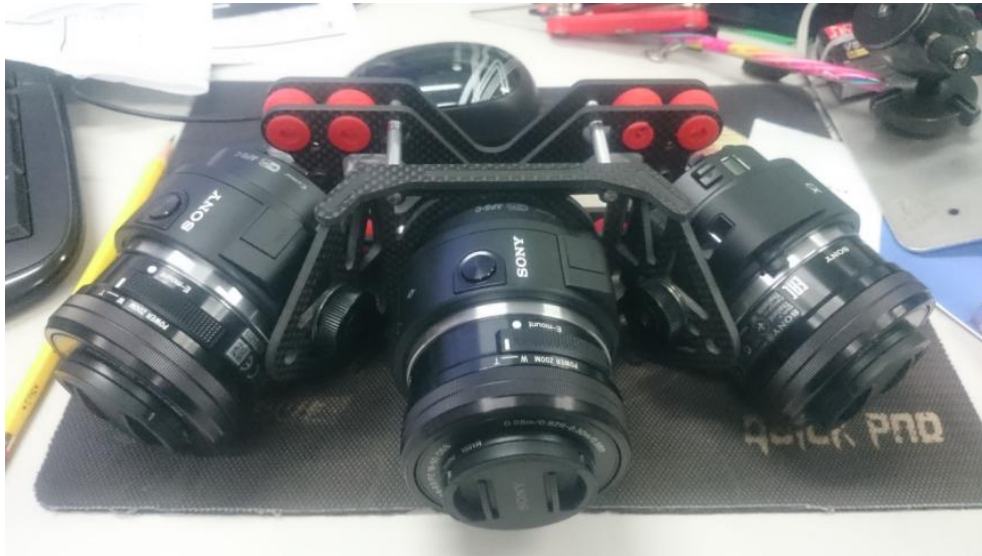
圖 6-25 三顆傾斜攝影相機架構設計示意
