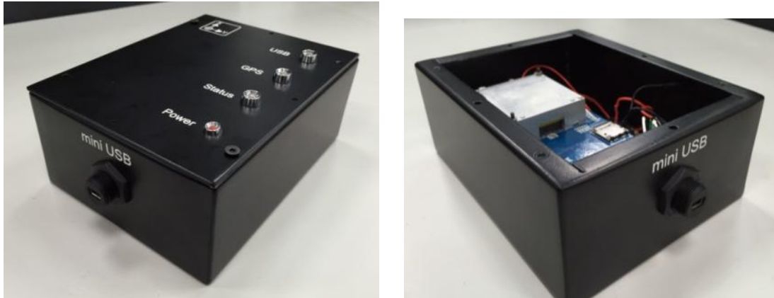
圖 5-17 系統整合硬體-外殼、電路與上蓋結合
