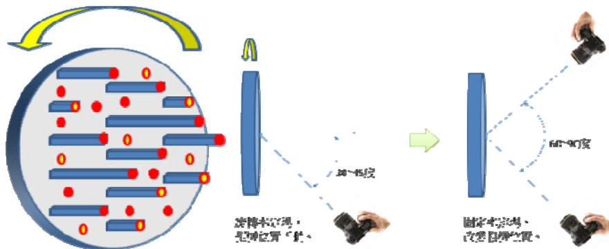
圖 5-23 單相機率定法拍攝方式示意圖
