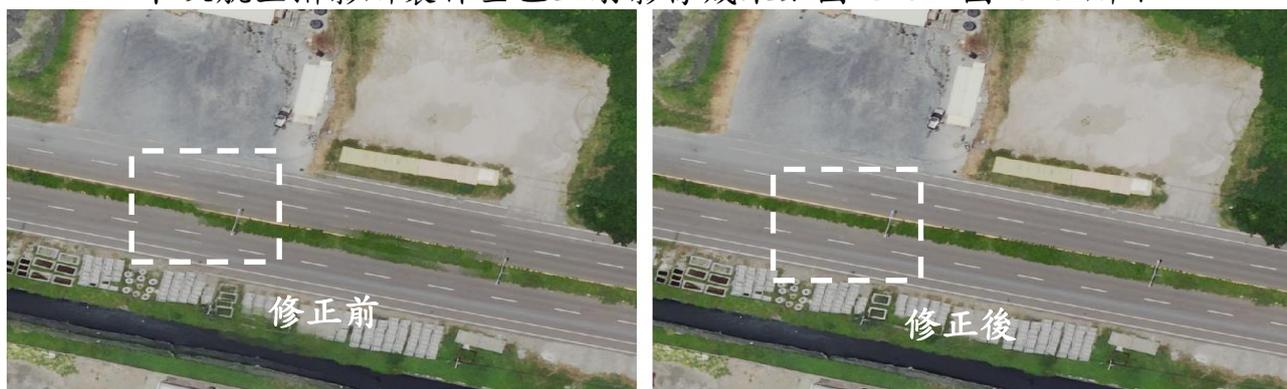
圖 3-59、正射影像接邊修正樣張
