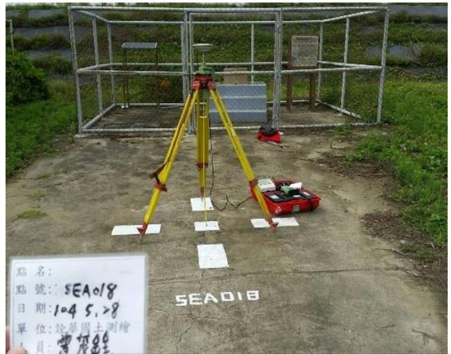
圖 3-44、航空標規格及實地布設情形
