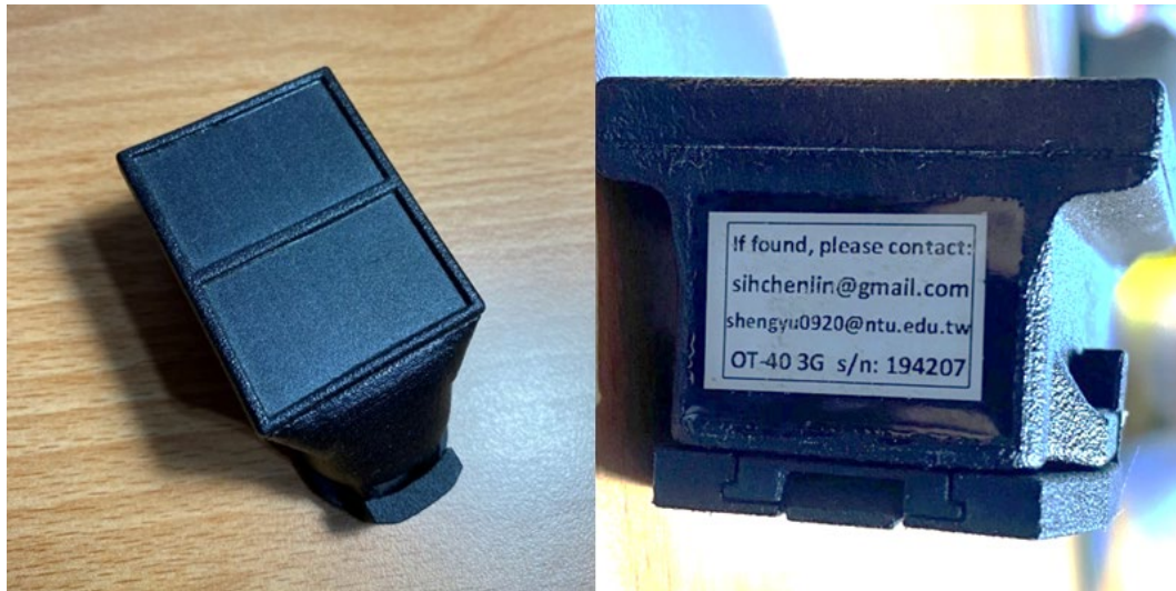
圖 3-1-2 本研究使用之 OrniTrack-40 太陽能衛星定位追蹤器
