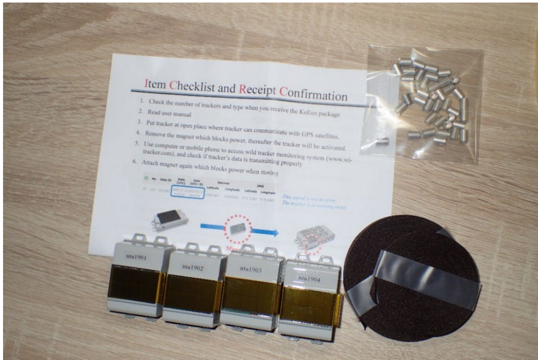
圖 3-1-1 本研究使用之 KoEco GPS-GSM 太陽能衛星定位追蹤器
