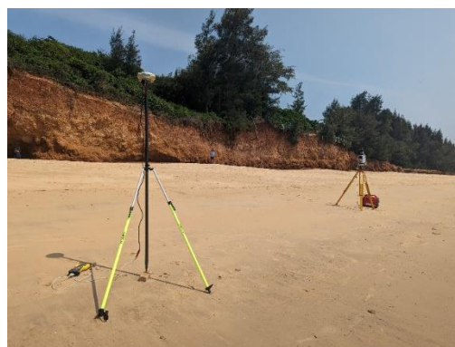
圖 3-61 利用 RTK 移動站作為臨時性控制點
