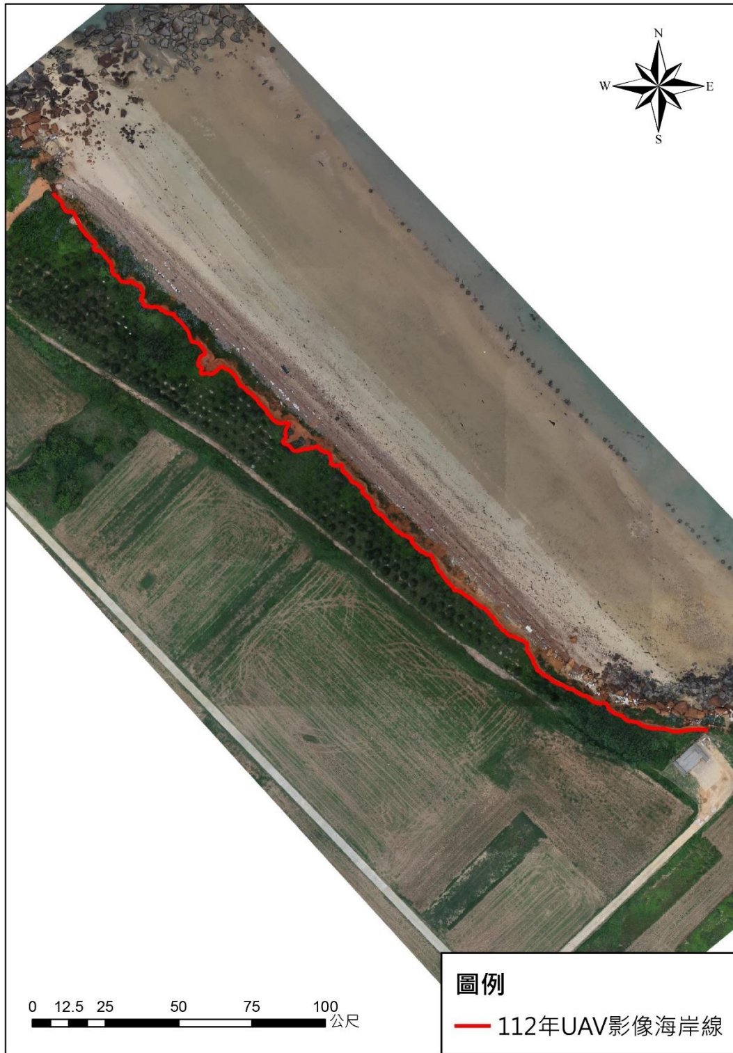
圖 5-17 古寧頭北山斷崖海岸 112 年 UAV 正射影像數化海岸線
