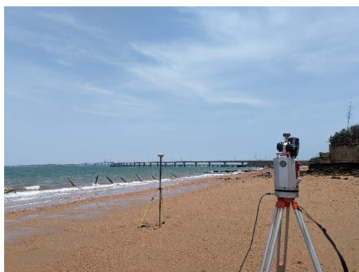
圖 3-61 利用 RTK 移動站作為臨時性控制點
