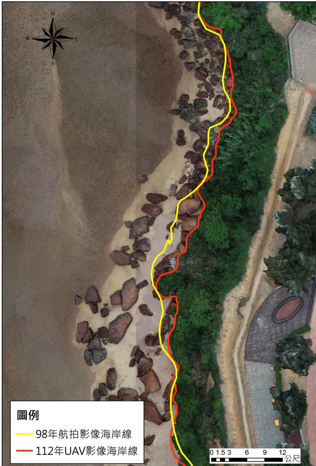
圖 5-25 烈嶼貓公石海岸線變化情形一局部放大 1 (最多後退 4.0 公尺)
