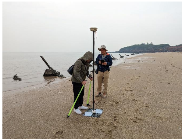
臨時布標 RTK 測量
