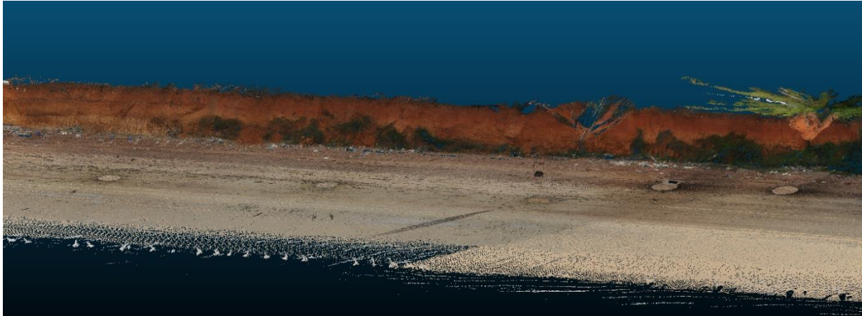
圖 3-67 古寧頭北山斷崖海岸點雲拼接成果
