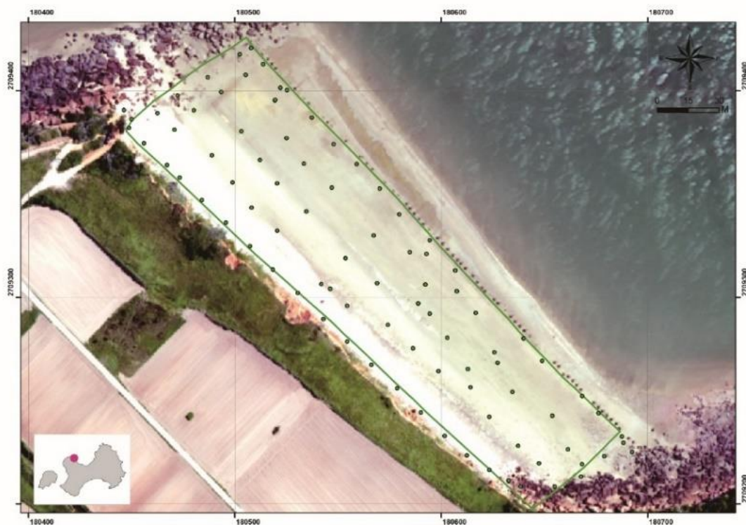
圖 3-11 RTK 測量點分布 (以 112 年 4 月古寧頭北山斷崖海岸為例)
