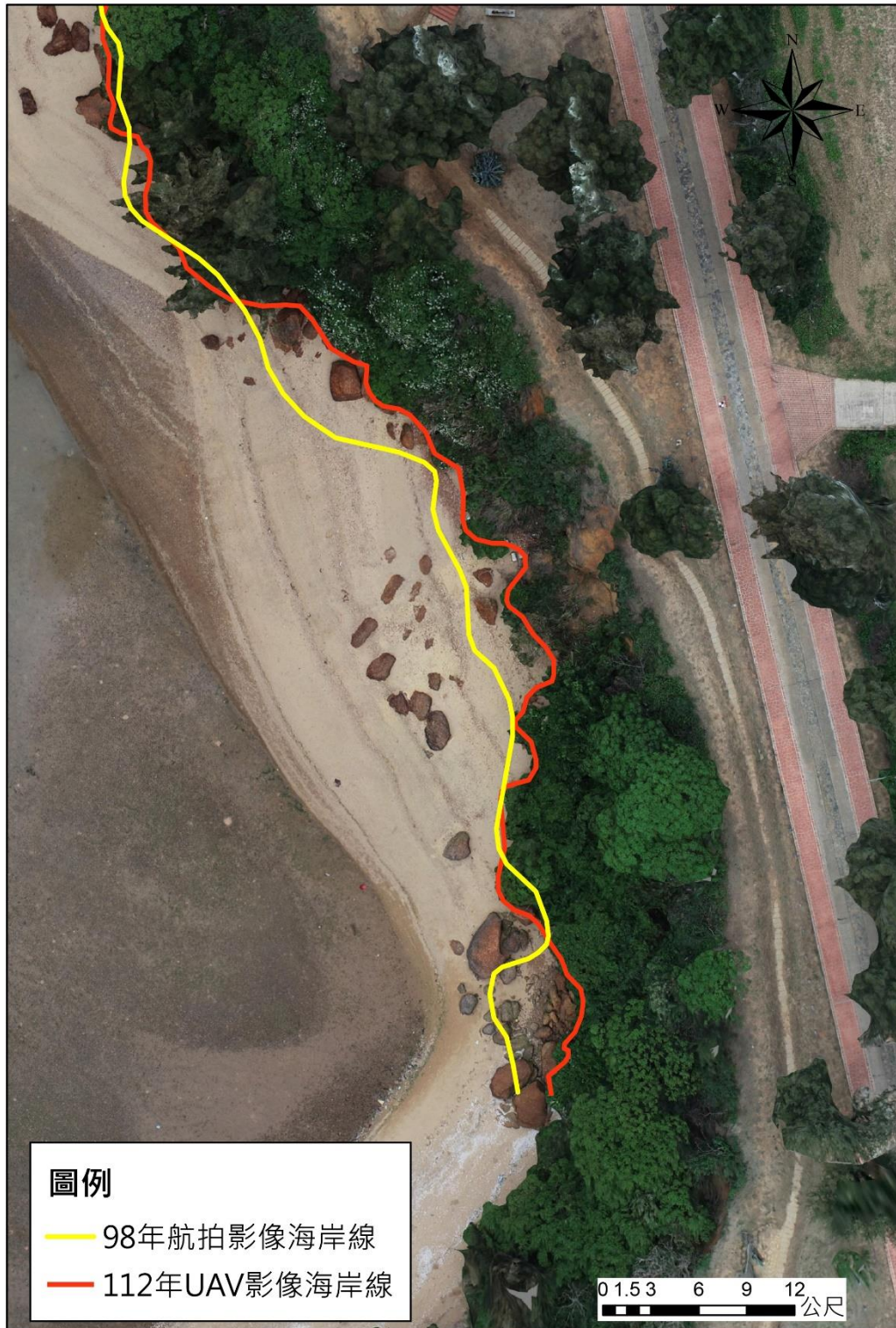
圖 5-27 烈嶼貓公石海岸線變化情形—局部放大 3 (最多後退 5.8 公尺)
