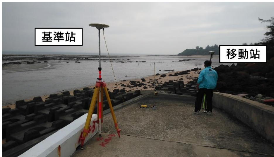
圖 3-8 RTK 測量作業情形 (以古寧頭北山海堤為例)
