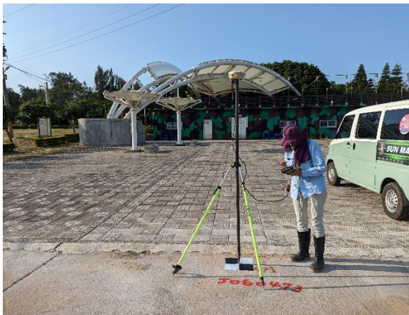
固定航空標 RTK 測量
