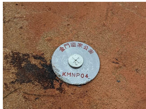
圖 3-4 新設控制點 (古寧頭北山斷崖海岸)
