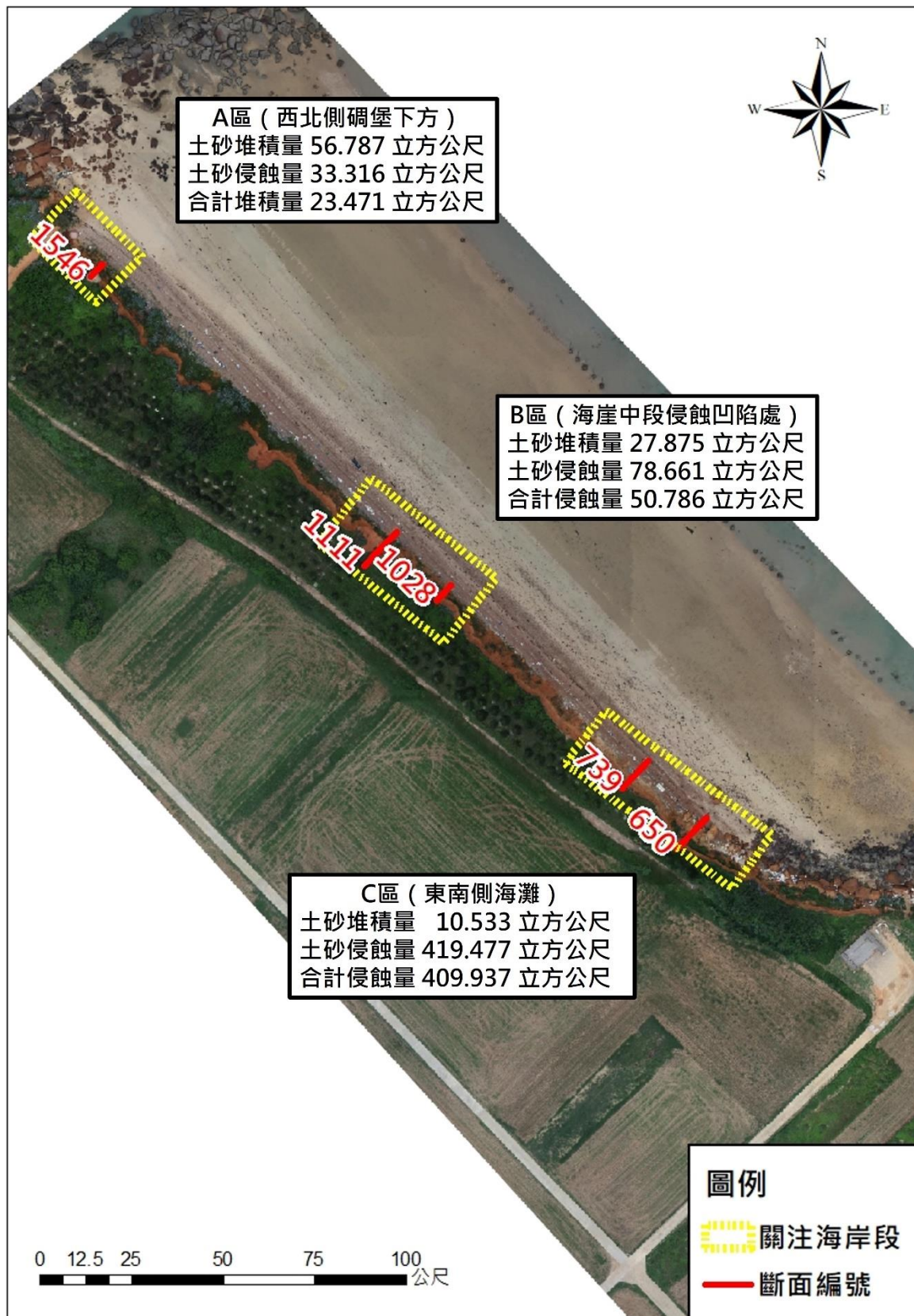
圖 3-80 古寧頭北山斷崖海岸變異分析關注岸段與断面位置
