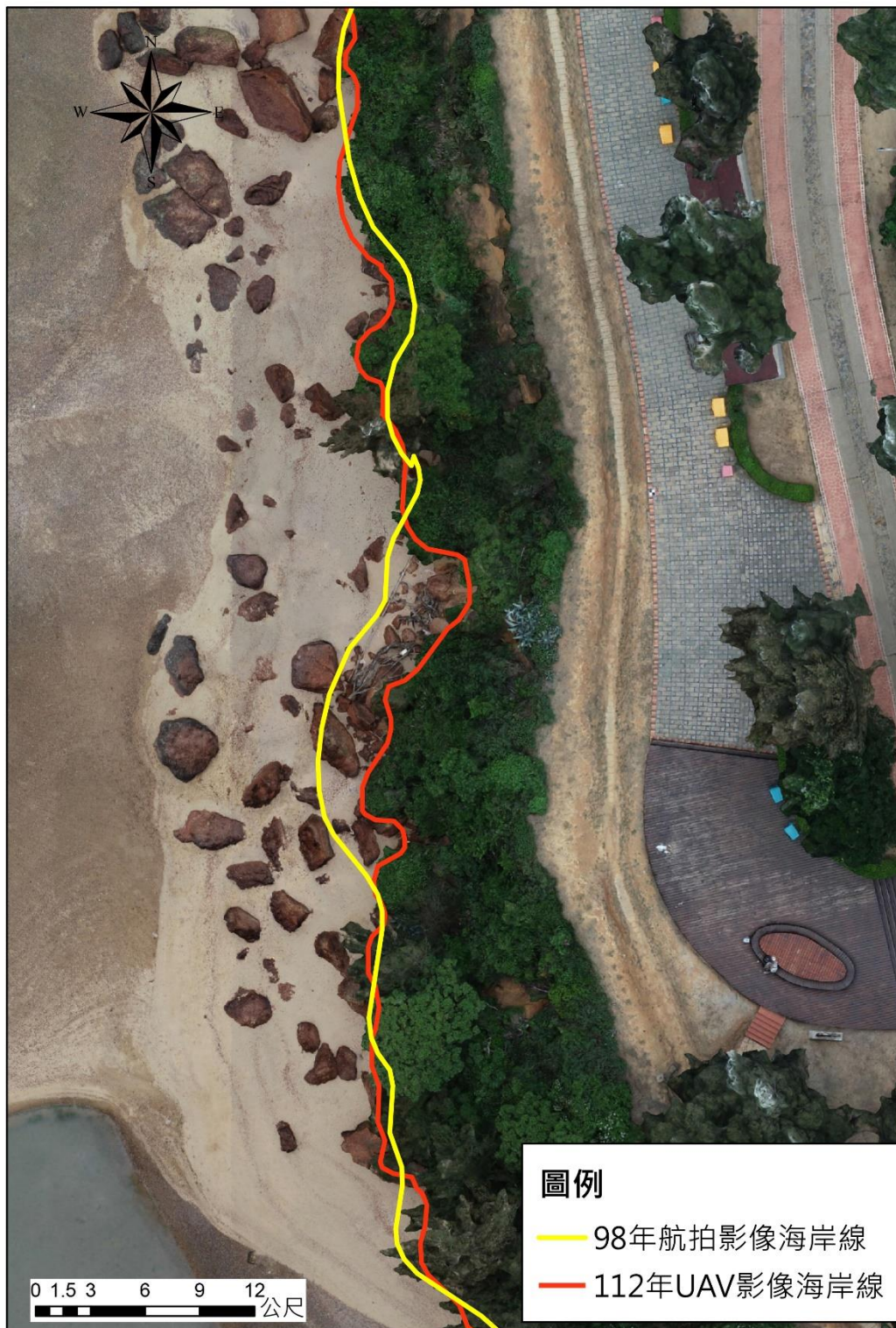
圖 5-26 烈嶼貓公石海岸線變化情形—局部放大 2 (最多後退 4.6 公尺)
