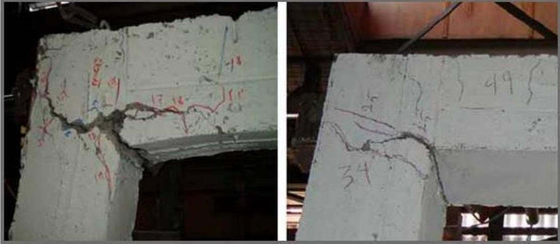
圖3-3-14 梁柱接頭產生裂縫(Facilitator, 2019)
