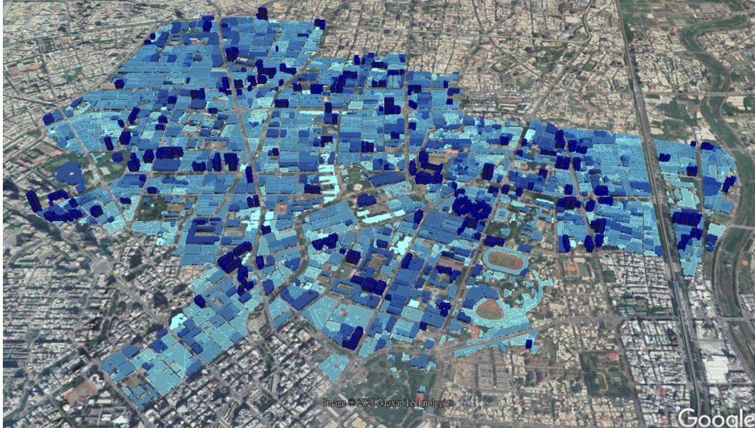
(a)利用「臺灣通用電子地圖區塊建物框」產製之三維建物模型
