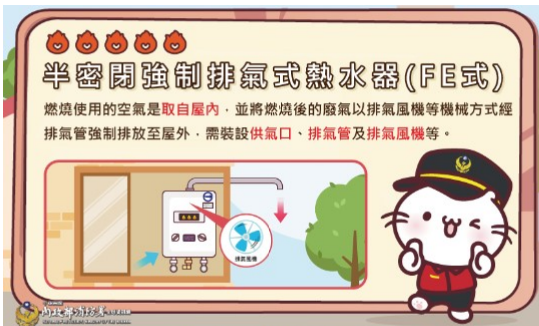
圖六：半密閉強制排氣式熱水器(FE式)
