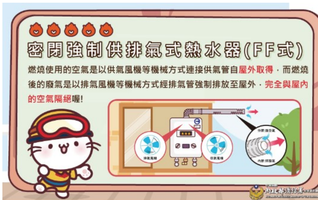
圖七：密閉強制供排氣式熱水器(FF式)
