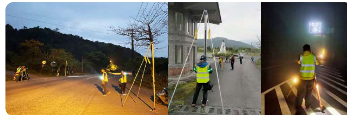
▲ 圖4-1 一等水準點正高檢測作業情形
