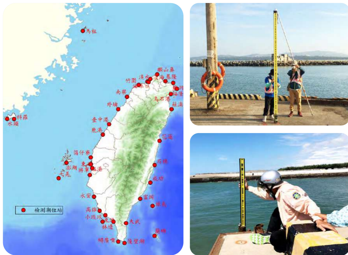
▲ 圖4-3 潮位站分布圖及高程基準檢測工作辦理情形
