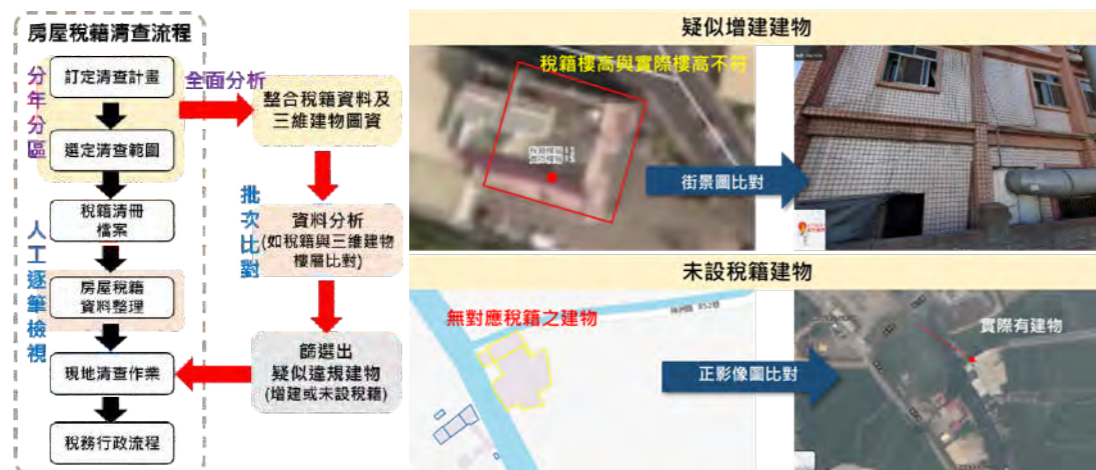
▲ 圖 4-43 三維建物模型輔助稅籍清查案例作業流程及成果驗證
