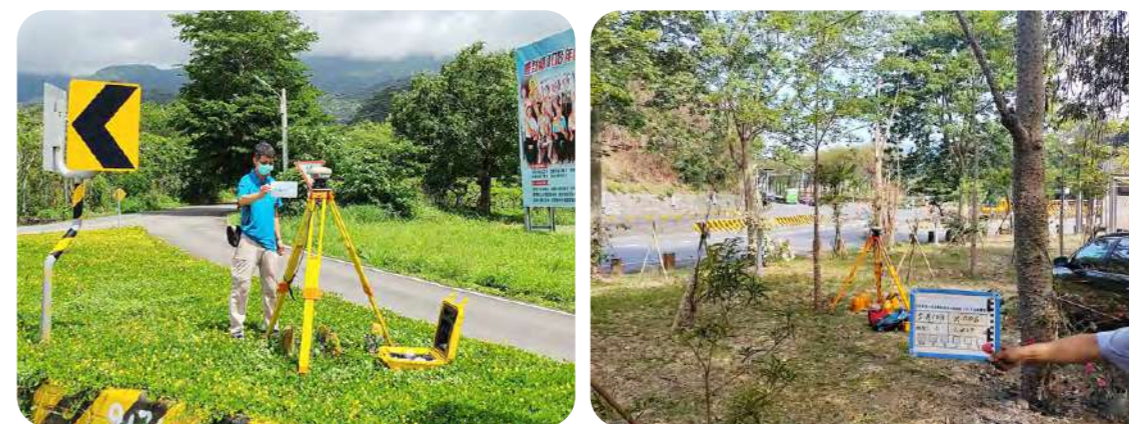
▲ 圖 4-6 一等水準點幾何高檢測作業情形
