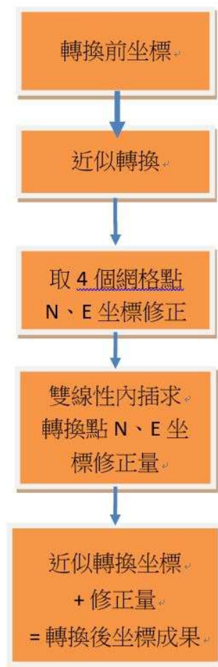
圖 二-4 「臺灣地區地籍測量坐標轉換程式」坐標轉換程序流程圖
