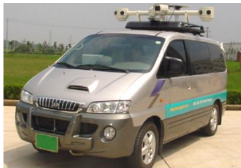
立得空間測量車LD-2000 RH (摘自Li et al., 2001)
