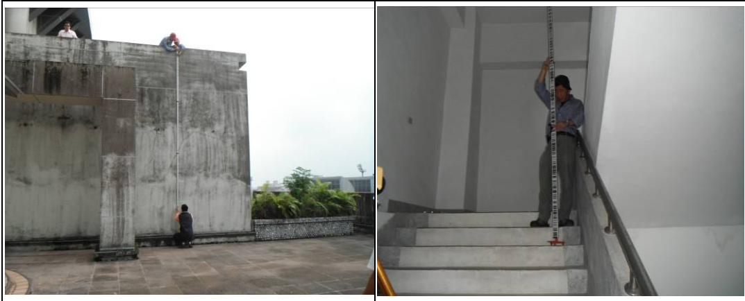
圖 1 普通水準測量作業情形
