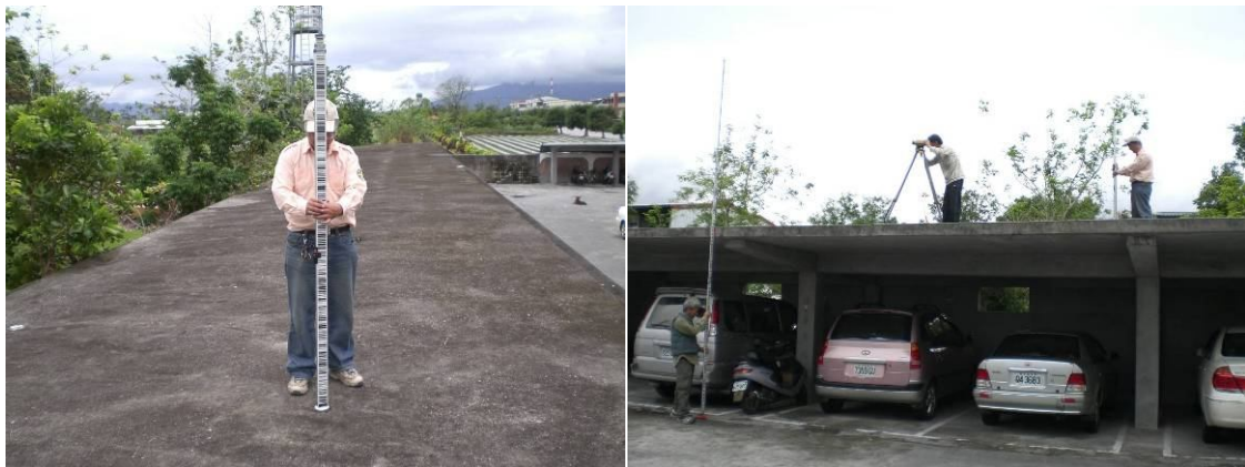
圖 1 普通水準測量作業情形
